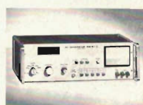
Generatore AM-FM stereo "TES" Mod. AF 1077 Frequenza: AM 140 kHz - 50 MHz FM: 9,5-12 MHz e 85-110 MHz Tensione d'uscita: 0,1 µV - 0,1 V Impedenza: 75 Ω Modulazione: interna-esterna Sottoportante: 19 kHz e 38 kHz
