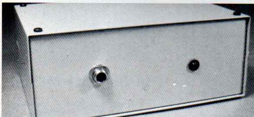
Trasmettitore a modulazione di frequenza sulla gamma 88-108 MHz con potenza di uscita di 2 Weff. Questo apparecchio, in unione all'alimentatore ed al mixer, consente a chiunque, con modica spesa, di installare una completa stazione FM la cui portante può raggiungere i 5 Km. L'emissione è caratterizzata dall'assenza di emissioni spurie e da una notevole fedeltà. L'apparecchio viene fornito completo di contenitore e di tutte le minuterie necessarie.
