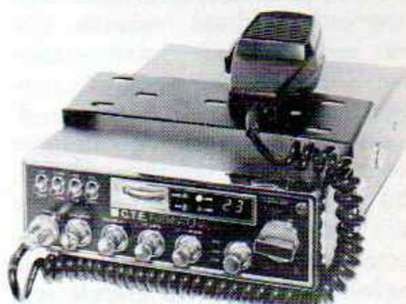
La stazione radio è venduta insieme ad un filtro (codice 27/286) di cui è obbligatorio l'impiego lungo la linea di antenna. L'apparato è di tipo PLL e dispone di 23 canali in AM e 46 in SSB; l'indicazione di canale è digitale ed al centro del pannello frontale è sistemato uno strumento indicatore s-meter e wattmetro di notevoli dimensioni.
