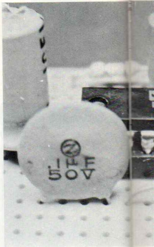
scita dell'amplificatore con l'altoparlante, mentre C5 da 100 KpF è il solito antidisturbo da piazzare il più vicino possibile al pin 2 dell'integrato. L'altoparlante è il classico miniatura da 8-16 ohm di impedenza e 0,4-1 watt di potenza.
