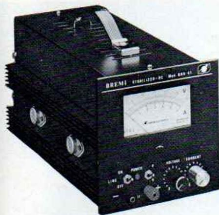
5 ampère. Il ripple in uscita è contenuto entro 200  $\mu$ V efficaci nelle condizioni massime di lavoro. Sul pannello frontale trova spazio un voltmetro-ampereometro con classe di precisione 1,5 a bobina mobile ed il circuito è protetto elettronicamente contro sovraccarichi di corrente o disturbi causati dalla radiofrequenza. Il limitatore di corrente è regolabile da 100 mA sino al limite massimo di lavoro.
