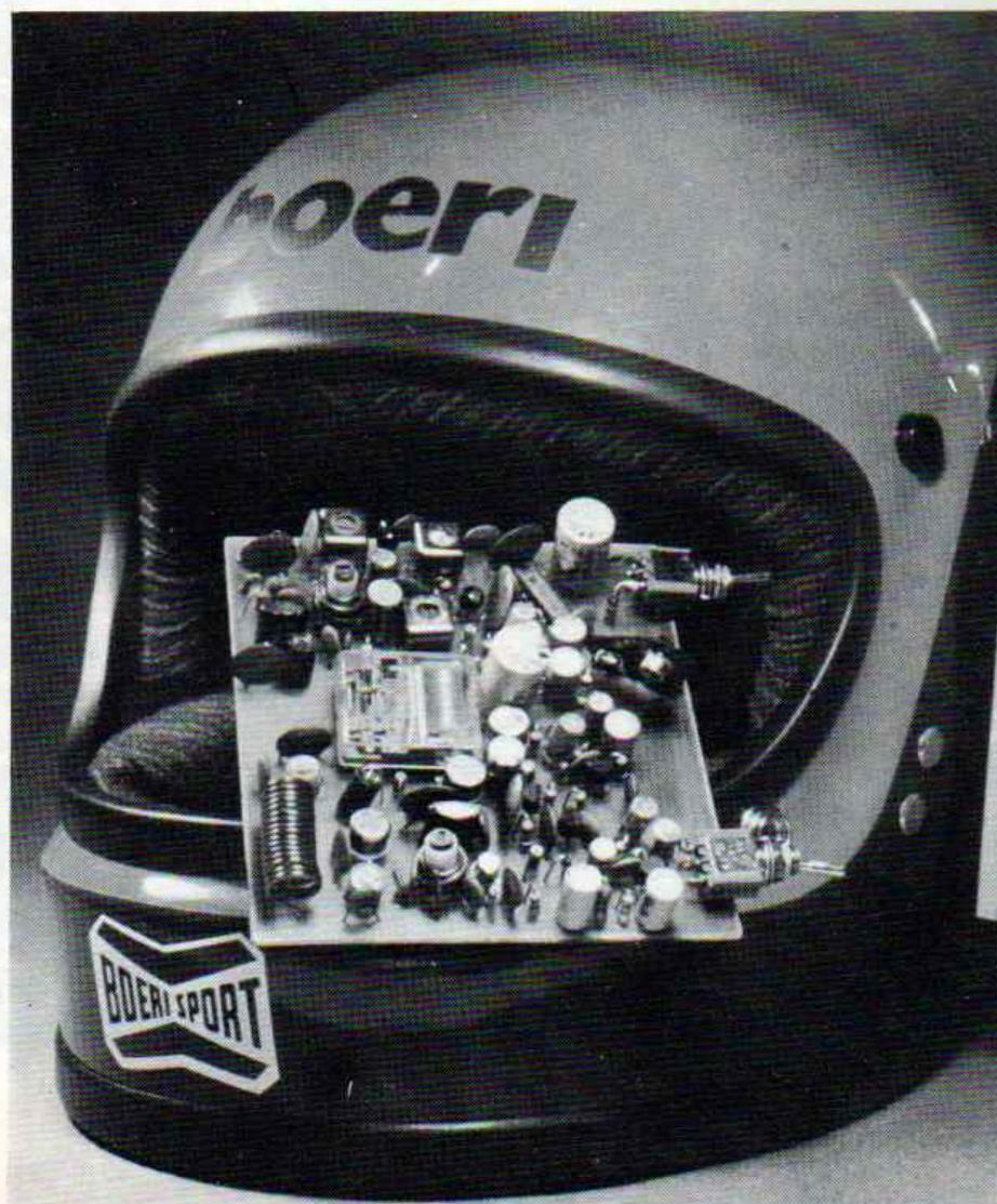
esattamente dal primo del valore di frequenza che si desidera ottenere. Per spiegarci meglio facciamo un esempio pratico, vediamo cioè che cosa succede nel nostro caso. Dovendo convertire la frequenza del segnale radio di 27,325 MHz in 455 KHz, dovremo miscelare il segnale d'ingresso con un segnale della frequenza di 26,870 MHz. All'uscita avremo due segnali differenti: la frequenza del primo sarà data dalla somma delle due frequenze, quella del secondo dalla differenza.
