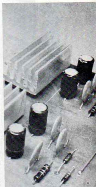
Stadio finale potenza 20 watt stereo! Realizzato con circuiti integrati, banda passante 20÷30.000 Hz; rapporto segnale disturbo migliore di 70 dB; sensibilità d'ingresso 300 mV; impedenza di uscita 4÷8 ohm; impedenza d'ingresso 100 Kohm.
