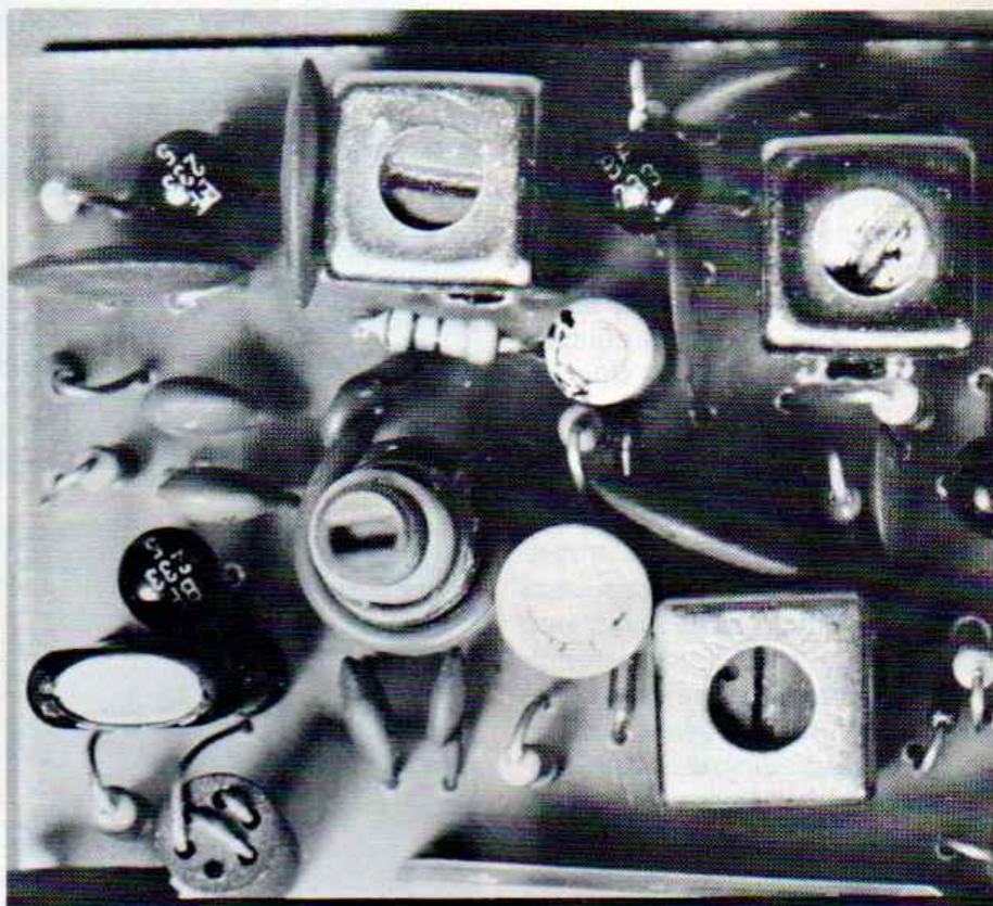
*Dettaglio del prototipo. Nell'immagine, le medie frequenze e la bobina L1 su cui bisogna agire in fase di taratura. Agendo in particolare su L1 si determina l'accordo della sintonia.*
