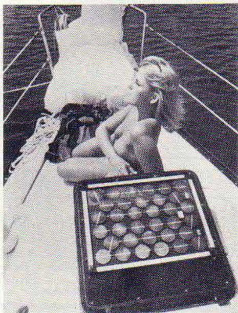
dell'acqua di mare in acqua potabile. Sono in pratica 34 fotocellule al silicio sistemate a prua (ingombro appena 36x46 cm) mentre l'impianto di dissalazione e le batterie per l'accumulo sono sottocoperta. Il processo di dissalazione avviene per il passaggio di corrente continua attraverso l'acqua salata in un serbatoio diviso in tre da due membrane, una per lo scorrere dei soli ioni positivi, l'altra per quello dei negativi. A lun-
