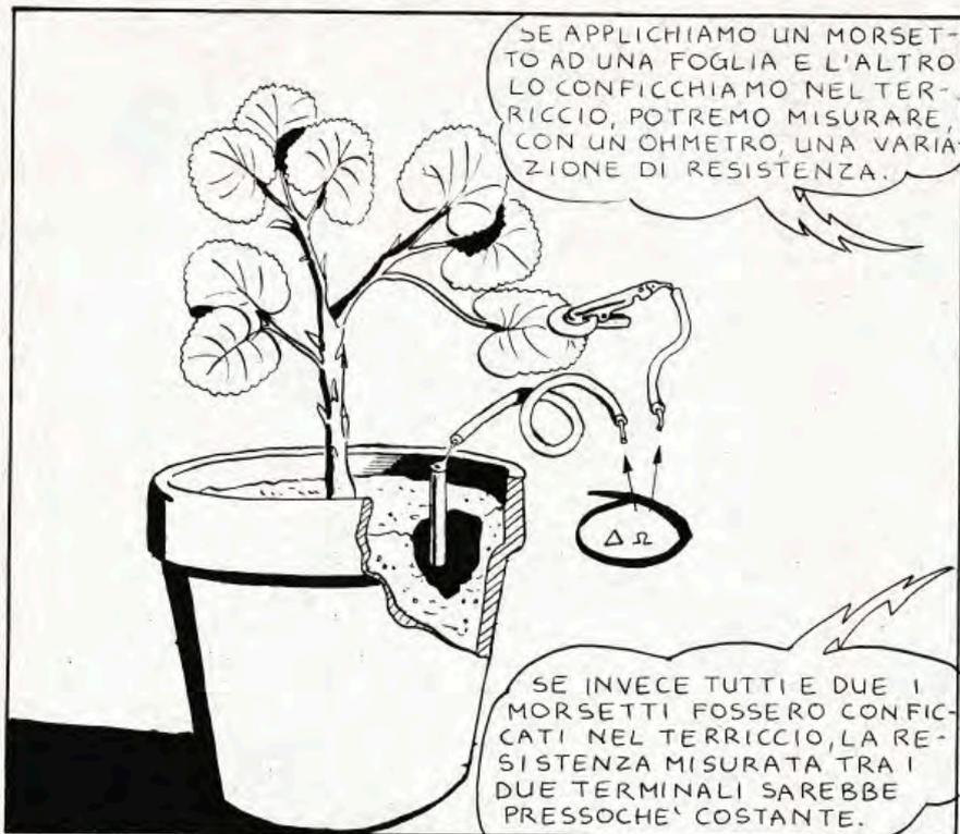
SE APPLICHIAMO UN MORSETTO AD UNA FOGLIA E L'ALTRO LO CONFICCHIAMO NEL TERRICCIO, POTREMO MISURARE, CON UN OHMETRO, UNA VARIAZIONE DI RESISTENZA.
