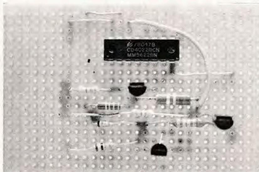
bi del tipo a variazione lineare. Il livello del segnale d'uscita può essere regolato tramite il potenziometro P3. La tensione nominale di alimentazione è di 9 volt.
