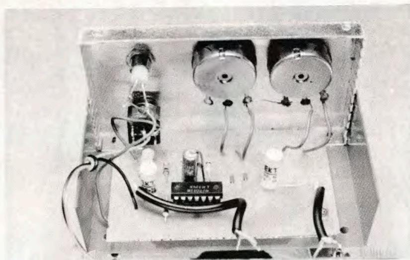
C2 pone dinamicamente a massa il pin 3 dell'integrato; ingresso ed uscita sono disaccoppiati rispettivamente da C1 e C4; P2 viene usato per regolare l'ampiezza del segnale uscente, ed è quindi il volume generale.
