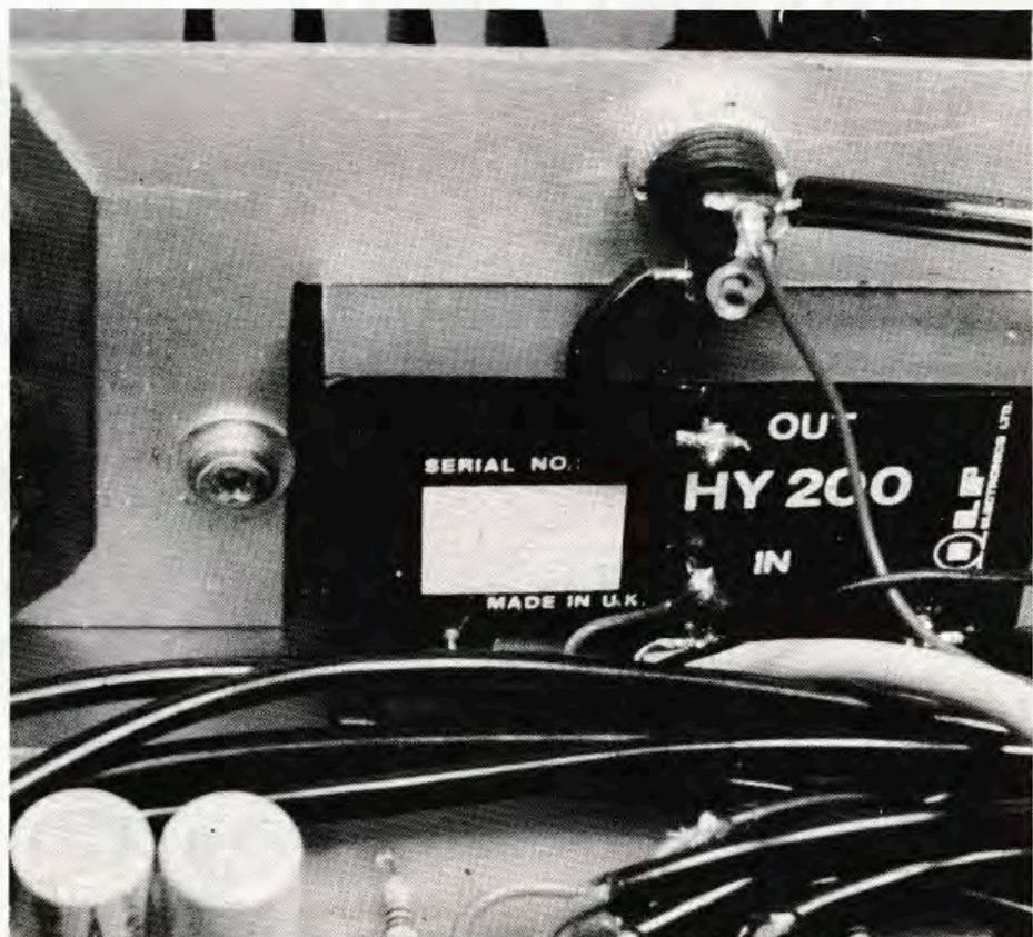
Dettaglio del circuito in cui è impiegato il modulo di potenza ILP HY200, in unione al preamplificatore stereofonico: un abbinamento particolarmente consigliabile.
