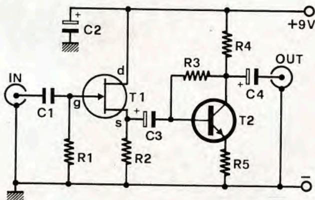
po; si tratta di un comunissimo 2N3819 che tutti voi conoscerete. Questo particolare semiconduttore, a differenza dei transistor bipolari, presenta intrinsecamente una elevatissima impedenza d'ingresso. Il secondo stadio fa capo al BC 108B montato
