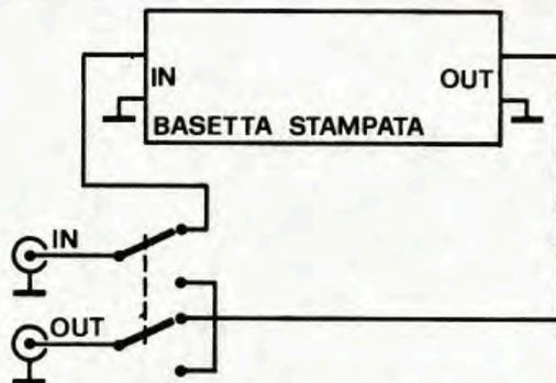
Nel disegno, il sistema di collegamento necessario per inserire o escludere con facilità un circuito per effetti sonori. La proposta è valida sia per questo preamplificatore per esaltazione dei bassi che per quello degli acuti, del fuzz, del tremolo e del controllo toni che troverete nelle prossime pagine. In pratica occorrono un doppio deviatore (meglio a pedale) e cavetti schermati per ogni collegamento.
