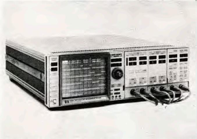
10x10 divisioni, possibilità di effettuare misure sia in « delta time » che in « delta voltage » ed un menu che si rende utile in mille occasioni: tutte queste caratteristiche sono presenti già nella versione base dello strumento.
