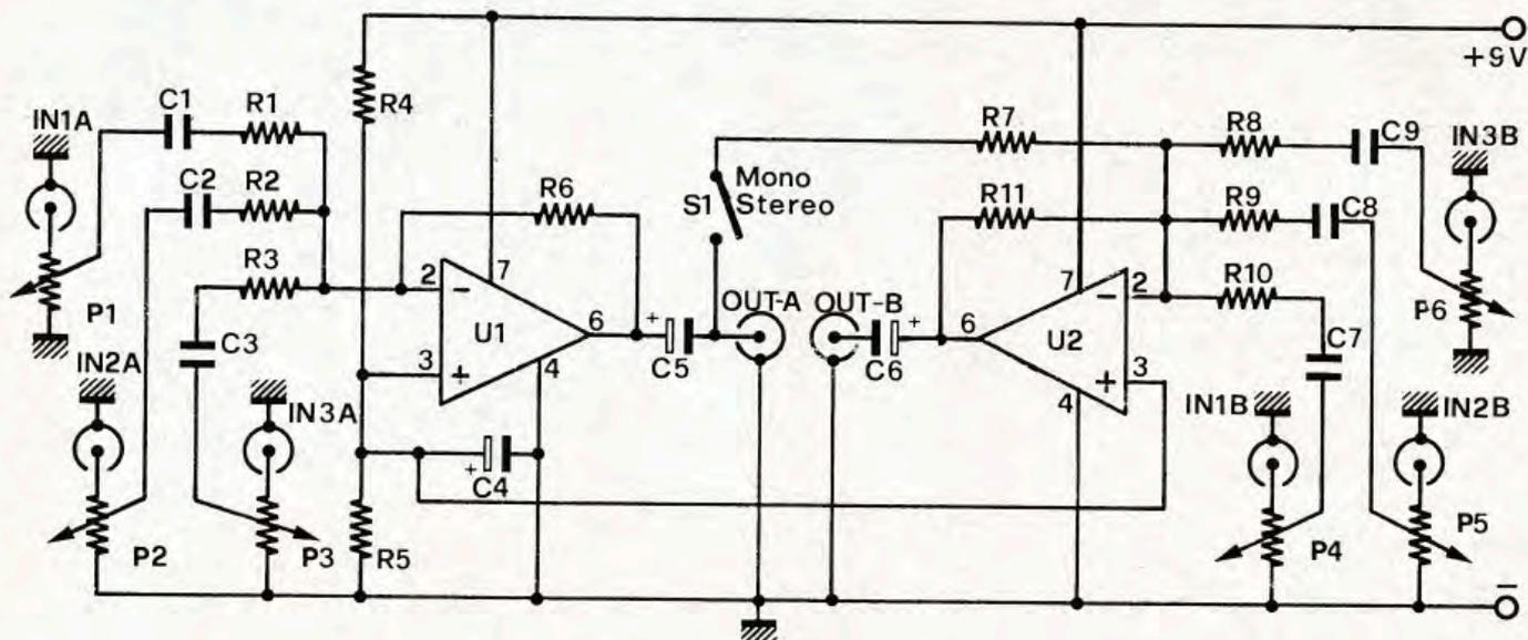
circuito con una tensione duale. Le resistenze di reazione R6 e R11 determinano il guadagno in tensione dei due stadi. Essendo i valori di tali resistenze identici a quelli delle resistenze d'ingresso, il guadagno risulta unitario. Alimentazione 9 V.
