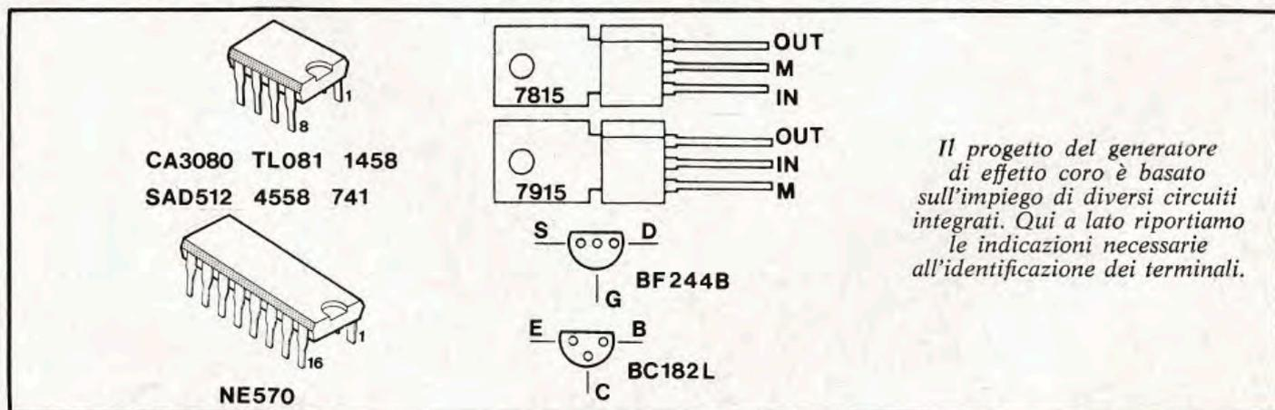
*Il progetto del generatore di effetto coro è basato sull'impiego di diversi circuiti integrati. Qui a lato riportiamo le indicazioni necessarie all'identificazione dei terminali.*
