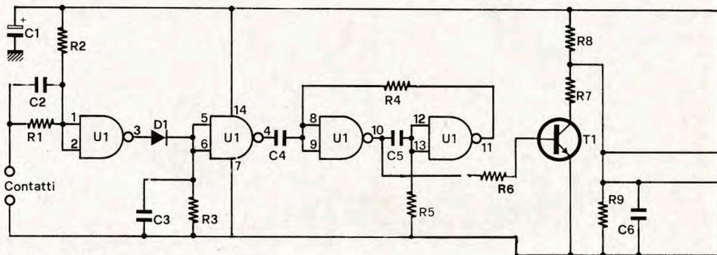
Toccando i contatti d'ingresso si ottiene il caratteristico suono degli strumenti a percussione.
