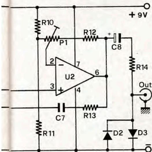
volta il segnale. Tramite il potenziometro R4 è possibile modificare il livello del segnale applicato al secondo stadio e quindi variare il grado di distorsione. In uscita, il segnale audio subisce un'ulteriore distorsione ad opera dei diodi D1 e D2, i quali « tagliano » i segnali di ampiezza superiore ai 600-700 mV. Il partitore formato da R9 e R10 dimezza l'ampiezza del segnale d'uscita che pertanto potrà presentare un'ampiezza massima di circa 300 mV.
