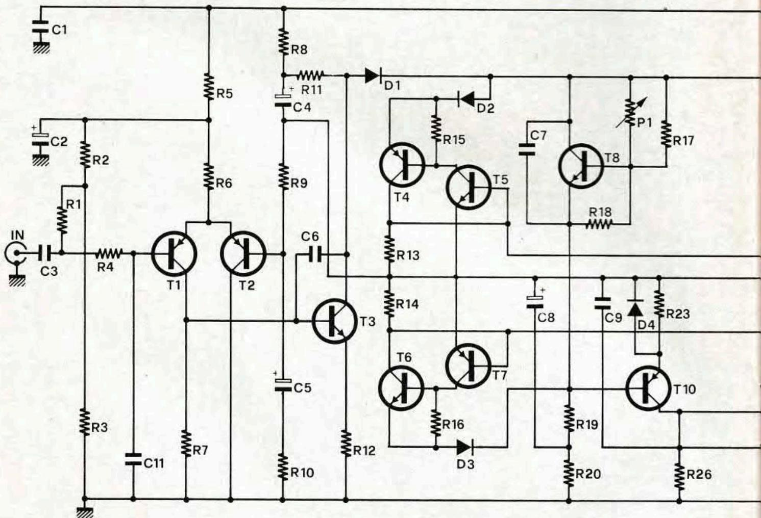
Circuito elettrico dello stadio finale BF: per ottenere 125 watt sono necessari ben 14 transistor.
