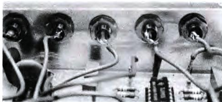
Il circuito stampato su cui sono montati tutti i componenti elettronici. E' consigliabile che gli otto trimmer delle serie Rb siano multigiri: ciò perché la taratura non diventi troppo critica.
