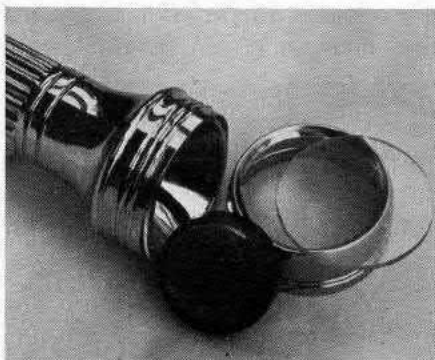
L'elemento sensibile alla luce, una fotoresistenza, disposto elegantemente nella parabola di una classica torcia tascabile.
