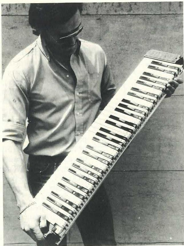
La tastiera a 5 ottave più il DO deve essere codificata mediante una matrice di diodi. I contatti debbono essere separati o, al massimo, possono avere in comune un terminale per ognuna delle cinque ottave; non sono adatte le tastiere con contatti a barra. In commercio, anche se sono difficili da reperire, esistono tastiere già codificate per l'integrato M108.
