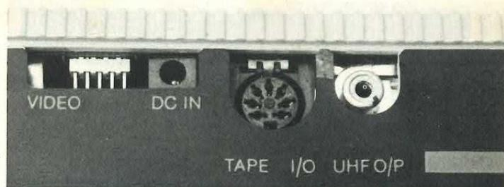
Per aumentare le capacità matematiche del vostro Atom dovete inserire nello zoccolo sotto la ROM da 8K del Basic, quella per la virgola flutuante. Sopra un particolare degli slot accessibili dal pannello posteriore. A sinistra l'Acorn Bus e la VIA.
