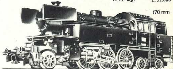
Della loco "CAVALLO NERO DELLE STEPPE" sono state acquisiti 95 esemplari impiegati per treni passeggeri e merci su linee principali e secondarie. I ferrovieri ne apprezzavano le eccellenti prestazioni. Prototipo N. 24074, potenza: 920 HP, peso: 99,2 t., velocità massima avanti/indietro: 90/50 Km/h.
