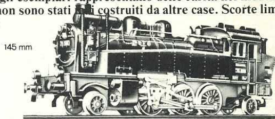
"LA PIERINA" Modello della famosa LOCOTENDER a 5 assi in uso su tutte le ferrovie europee ed anche italiane per trazione merci pesanti su lunghi percorsi. Superba riproduzione curata nei minimi particolari. Funzionamento perfetto dei bellissimi sistema Heusinger. Trazione su tutte le ruote biellate di cui quattro gommate. cod. LCV 3
