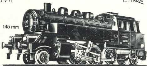
Prototipo N. 064389-0, potenza 950 HP, peso 74,9 t., velocità massima 90 Km/h. Esemplari acquisiti 520 per l'impiego di treni leggeri passeggeri e merci.
