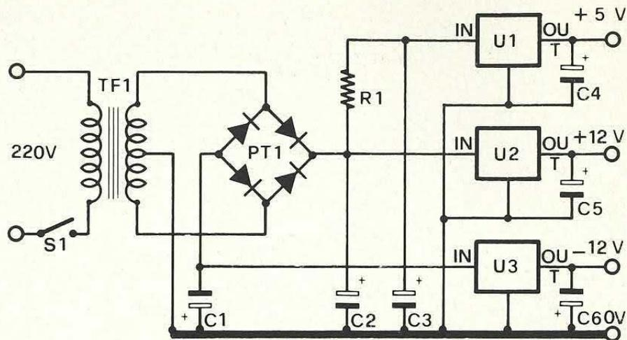
Il circuito di alimentazione fornisce tre tensioni continue stabilizzate: +5 volt e  $\pm 12$  volt. Il trasformatore di alimentazione fornisce una tensione alternata di 18+18 volt che viene raddrizzata dal ponte di diodi e filtrata dai condensatori C1 e C2. Sul ramo positivo sono presenti due regolatori a 3 pin per ottenere le tensioni di +5 e +12 volt mentre sul ramo negativo è presente un altro stabilizzatore per ottenere i -12 volt.
