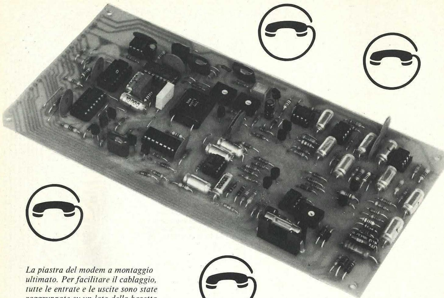
La piastra del modem a montaggio ultimato. Per facilitare il cablaggio, tutte le entrate e le uscite sono state raggruppate su un lato della basetta.
