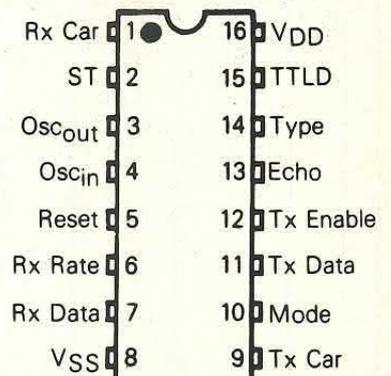
Funzioni relative ai terminali dell'integrato MC14412 utilizzato nel circuito del modem. Nel nostro caso deve essere impiegata la versione VP di tale integrato che necessita di una tensione di alimentazione di 5 volt.
