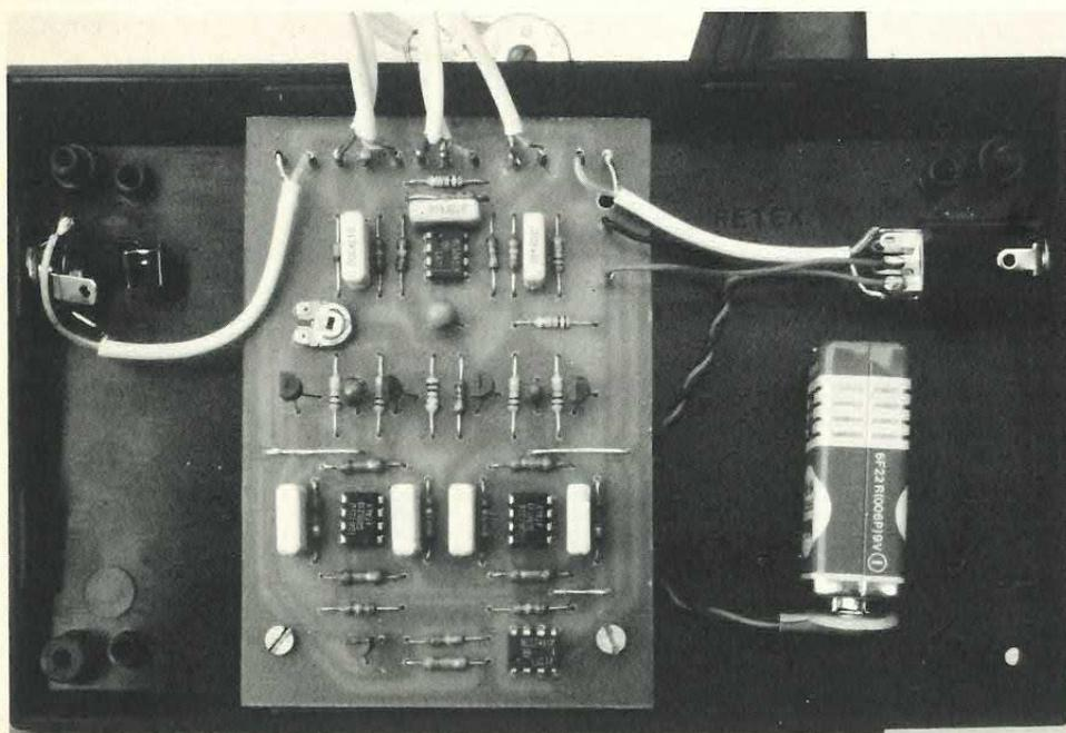
sono stati usati come amplificatori differenziali, l'unica particolarità è quella di aver applicato all'ingresso non invertente non una semplice rete resistiva, ma un filtro RC modulabile da un oscillatore. Esso è modulabile in quanto il FET viene utilizzato come resistenza variabile. Infatti la resistenza tra il SOURCE e il DRAIN varia proporzionalmente rispetto al segnale applicato al GATE.
