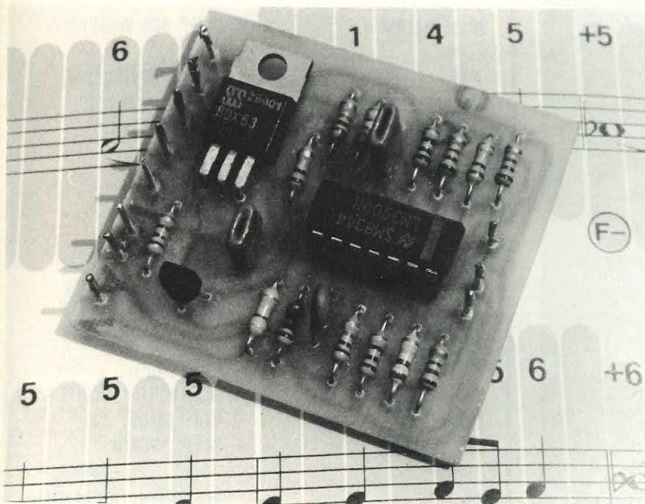
Il «cuore» del circuito è costituito dall'integrato LM3900 al cui interno troviamo quattro amplificatori operazionali. Con i quattro op-amp vengono realizzati due oscillatori che si controllano a vicenda. Normalmente il circuito produce tutta una serie di suoni «spaziali» ma, modificando opportunamente alcuni valori, è possibile trasformare questo circuito in una sirena bitonale. La potenza di uscita, grazie al Darlington T2, è di circa 5 watt a 12 volt.
