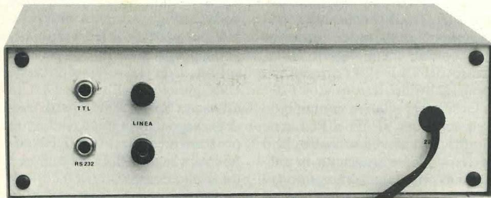
prototipo, come si può vedere nelle foto, il modem è stato inserito all'interno di un contenitore metallico della Ganzerli. Sul pannello frontale abbiamo fissato i quattro led, il commutatore S2 e tre deviatori a levetta; sul retro sono presenti le prese TTL, RS232 e la presa per la linea telefonica.
