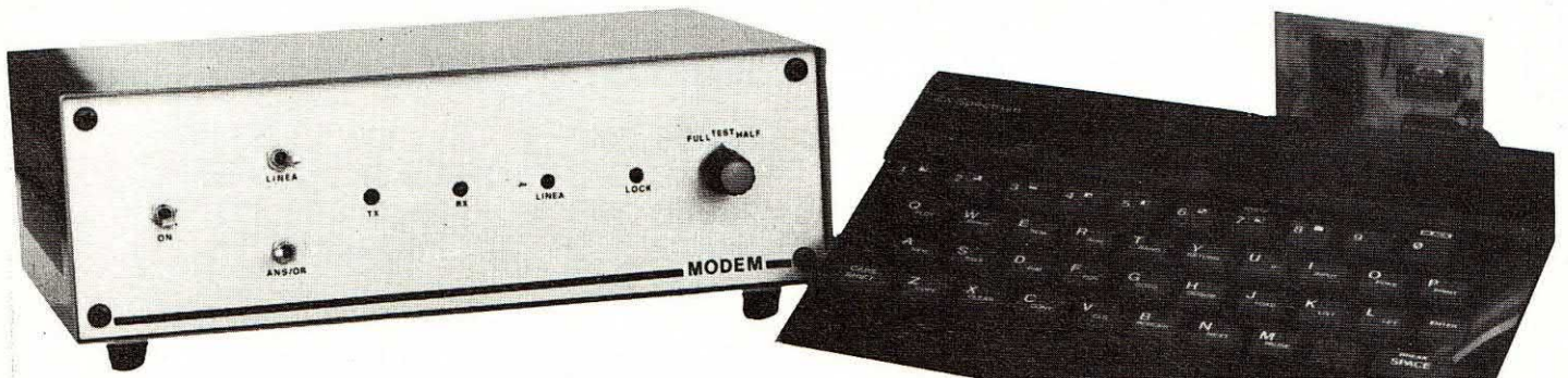
Il collegamento tra Spectrum e modem va effettuato con cavetto a tre poli (in, out, massa) di lunghezza non superiore ai 20-30 centimetri.
