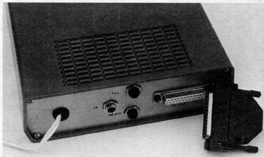
Il chip dell'AMI e il trasformatore di linea (sotto). Sopra: il retro del modem con il connettore full RS232, le prese «3X» TTL e RS232 nonché la presa per il telefono.
