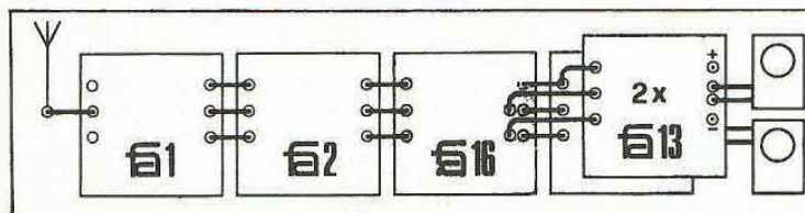
Un esempio di apparecchio realizzato con i kit Modular System: un ricevitore FM stereo 88 + 108 MHz, 10 + 10 W.
