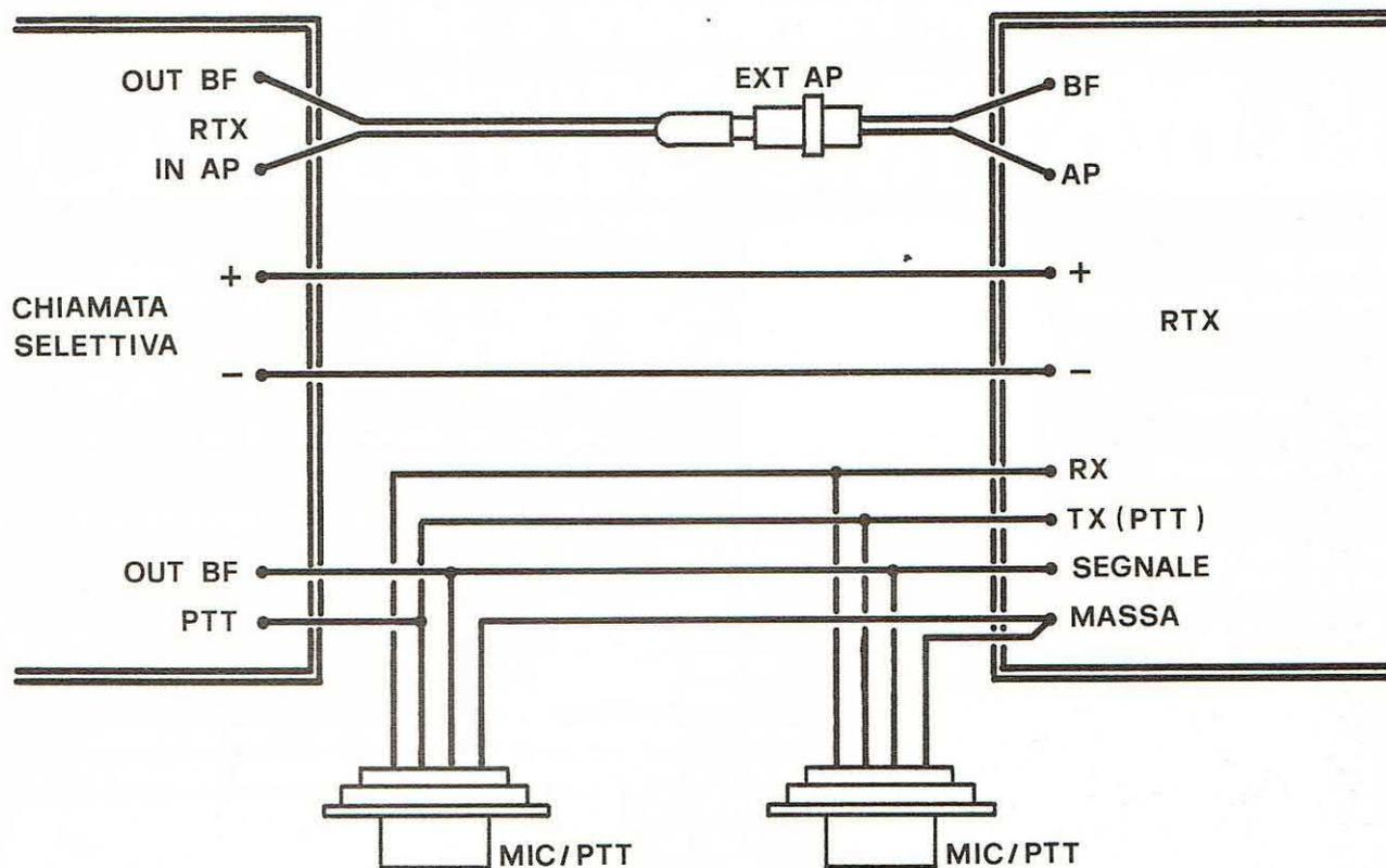
**I COLLEGAMENTI** - Schema dei collegamenti tra il circuito della chiamata selettiva e l'RTX. A questo proposito bisogna osservare che non sempre i contatti BF e AP dell'RTX corrispondono con la presa per altoparlante esterno. In un caso del genere è necessario interrompere il collegamento che, all'interno dell'RTX, va dall'uscita dell'amplificatore BF al lato «caldo» dell'altoparlante.
