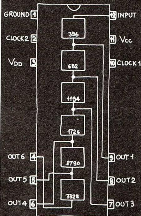
È il cuore del nostro progetto. Si chiama MN3011 ed è prodotto dalla Matsushita. L'integrato (vedi schema a blocchi) è uno shift register analogico a sei stadi per complessivi 3328 passi. Limitando la banda passante a 3,6 KHz, esso è in grado di produrre un ritardo di oltre tre secondi. In pratica le prestazioni di questo dispositivo sono paragonabili a quelle di sei SAD512 collegati in cascata.
