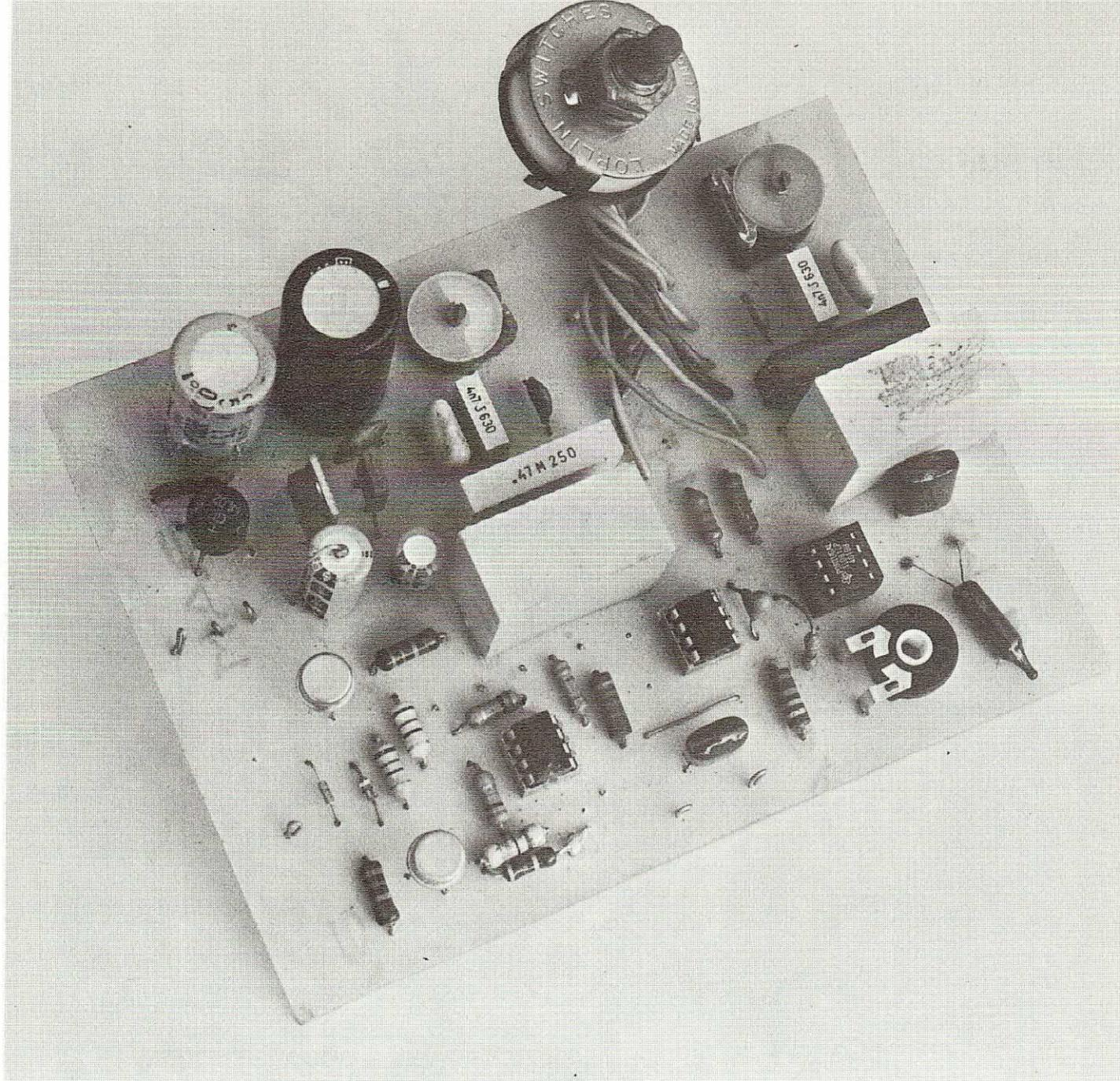
segnale alternato anche una tensione continua (offset). L'ampiezza di quest'ultima tensione può essere regolata da  $-10$  a  $+10$  V, agendo opportunamente sul potenziometro R10. S2 ci dà la possibilità di programmare due diversi fattori di amplificazione quando è aperto, tutto lo stadio amplifica due volte e quindi all'OUT l'ampiezza del segnale è di circa 8 Vpp; quando
