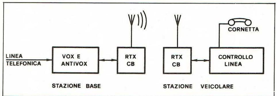
che vi proponiamo è l'impiego dei due ricetrans per realizzare un'apparecchiatura originale che vi consentirà di ricevere le telefonate in automobile entro un raggio (dalla vostra abitazione) direttamente proporzionale alla potenza dei ricetrasmittitori impiegati.
