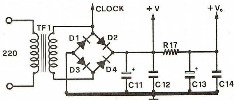
Il segnale di clock necessario al funzionamento dei contatori viene ottenuto prelevando la tensione alternata presente ai capi del secondario del trasformatore di alimentazione.
