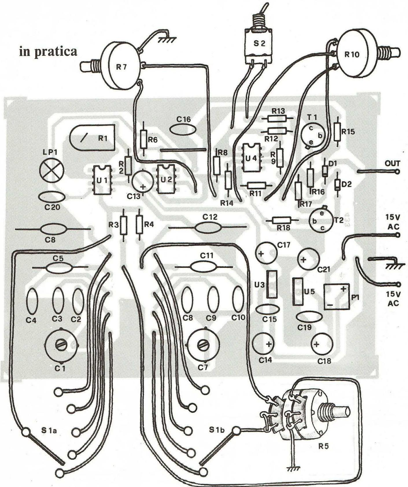
in questo caso aumenta anche la parte di segnale retrocesso al piedino 2 di U1, il quale diminuisce in proporzione la propria amplificazione, riportando il segnale al suo piedino 6 al livello di origine. Se invece l'ampiezza del segnale in uscita tende a diminuire, in base a quanto detto in precedenza, la resistenza della lampada diminuisce. Si ha allora una diminuzione del segnale retroces-
