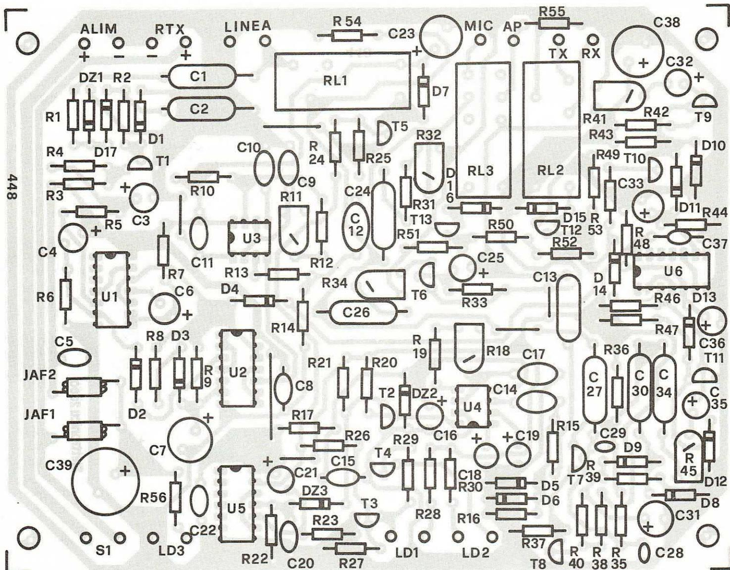
Normalmente ai capi della linea telefonica è presente una tensione continua che non può oltrepassare la barriera rappresentata dal condensatore C1; il transistor T1 pertanto non risulta polarizzato e la sua tensione di collettore presenta un livello logico alto. Quando giunge una chiamata il transistor T1 entra in conduzione e pertanto la sua tensione di collettore scende praticamente
