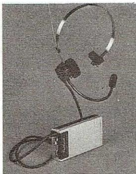
A batterie, pesante solo 250 gr, ecco dalla CTE una simpatica ricetrasmittente. Il microfono/cuffia, ultraleggero può essere tenuto in testa senza che dia il minimo fastidio, e l'unità ricetrasmittente può essere facilmente applicata alla cintura.
