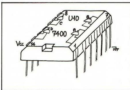
*perché i componenti della più costosa serie LS hanno una velocità di lavoro superiore e non ammettono sostituzione. Per quanto riguarda la piedinatura non ci sono problemi, la disposizione delle porte logiche in essi contenute è identica.*
