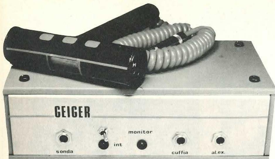
alimentatore. In presenza di radioattività ad ogni scarica del tubo geiger corrisponderà un impulso che verrà regolarmente registrato sul display. Per più complete informazioni su questo circuito vedere i nostri fascicoli di
