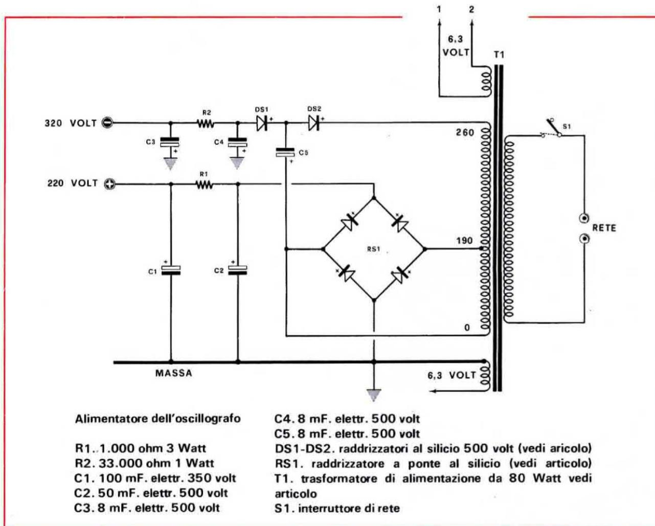
come pure gli S4-S5, ed il primo (S2-S3) serve per commutare l'oscillografo sulla posizione « SINCRONISMO ESTERNO » o « SINCRONISMO INTERNO » (nel disegno e riportata la commutazione su « Sincronismo interno ») mentre il secondo (S4-S5) serve per escludere l'oscillatore a dente di sega e quindi per utilizzare l'ENTRATA ORIZZONTALE onde applicarvi un segnale esterno sfruttando così l'oscillografo per avere sullo schermo le figure di Lissajous.
