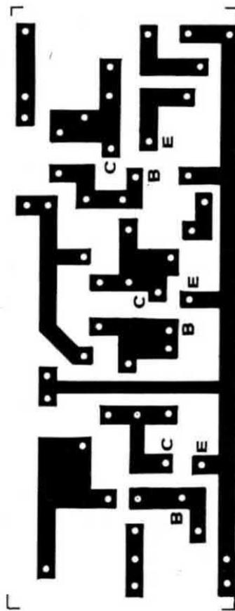
Fig. 3 (in alto) Disposizione dei componenti relativo al ricevitore per ultrasuoni sul circuito stampato da noi proposto. La bobina L.1 verrà fissata a parte entro la scatola metallica che schermirà tutto il ricevitore possibilmente vicino alla capsula microfonica piezo. L'uscita del ricevitore andrà poi a collegarsi al dispositivo d'innesco presentato a pag. 1026 che potremo inserire sempre entro alla stessa scatola cui è stato posto il ricevitore.
