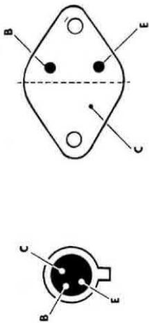
Disposizione del terminale dei transistor utilizzati nel progetto. Ricordarsi che il transistor TR2 andrà fissato sopra ad un'aletta di raffreddamento per dissipare il calore generale durante il suo funzionamento.
