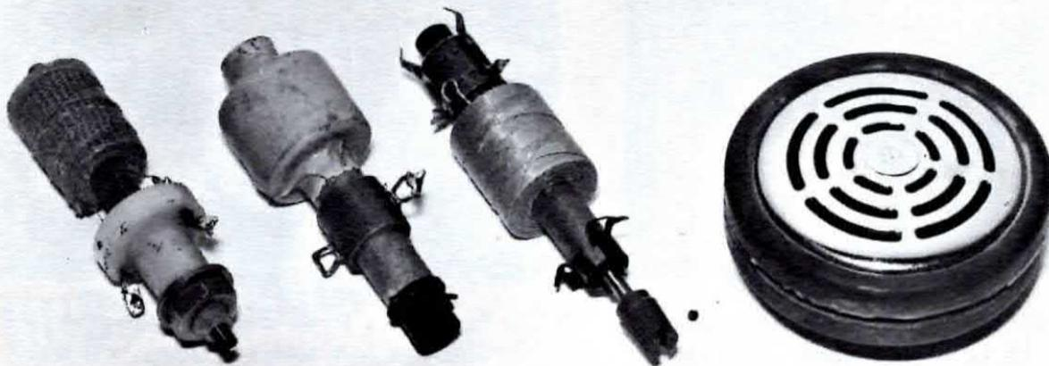
**Fig. 4** In questa foto sono visibili tre tipi di bobine L.1 adatte al nostro circuito che troverete con facilità in ogni negozio radio. La prima bobina a sinistra, richiedeva per poterla fare oscillare sui 20.000 Hz., una capacità di 220.000 pF. per C2 e 33.000 pF per C3, le altre due invece 33.000 pF. per C2 e 4.700 pF. per C3. A destra vi presentiamo la capsula microfonica piezoelettrica Geloso impiegata per il generatore ed il ricevitore.
