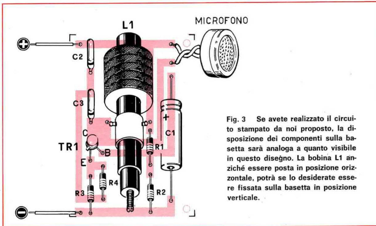
Fig. 3 Se avete realizzato il circuito stampato da noi proposto, la disposizione dei componenti sulla bassetta sarà analoga a quanto visibile in questo disegno. La bobina L1 anziché essere posta in posizione orizzontale, potrà se lo desiderate essere fissata sulla bassetta in posizione verticale.
