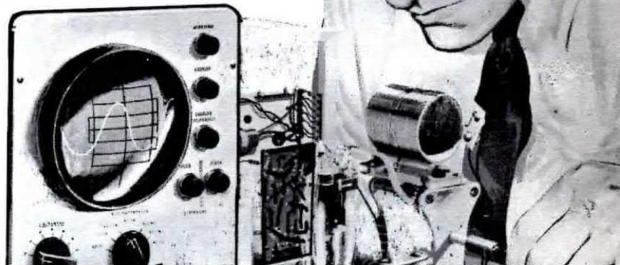
**Collegato al ricevitore per gli ultrasuoni od a qualsiasi altra apparecchiatura, questo dispositivo ci permetterà, in presenza di un segnale, di accendere una lampadina o far scattare un relè.**
