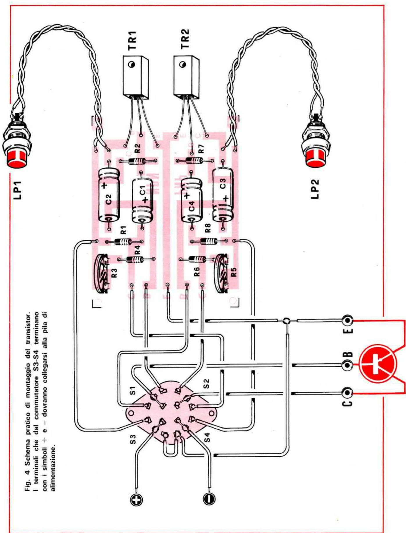
Fig. 4 Schema pratico di montaggio dei transistor. I terminali che dal commutatore S3-S4 terminano con i simboli + e - dovranno collegarsi alla pila di alimentazione.
