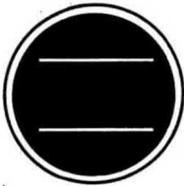
Due tracce in assenza di segnale. Regolando il potenziometro R5 si potrà avvicinare, distanziare, o sovrapporre le due tracce.
