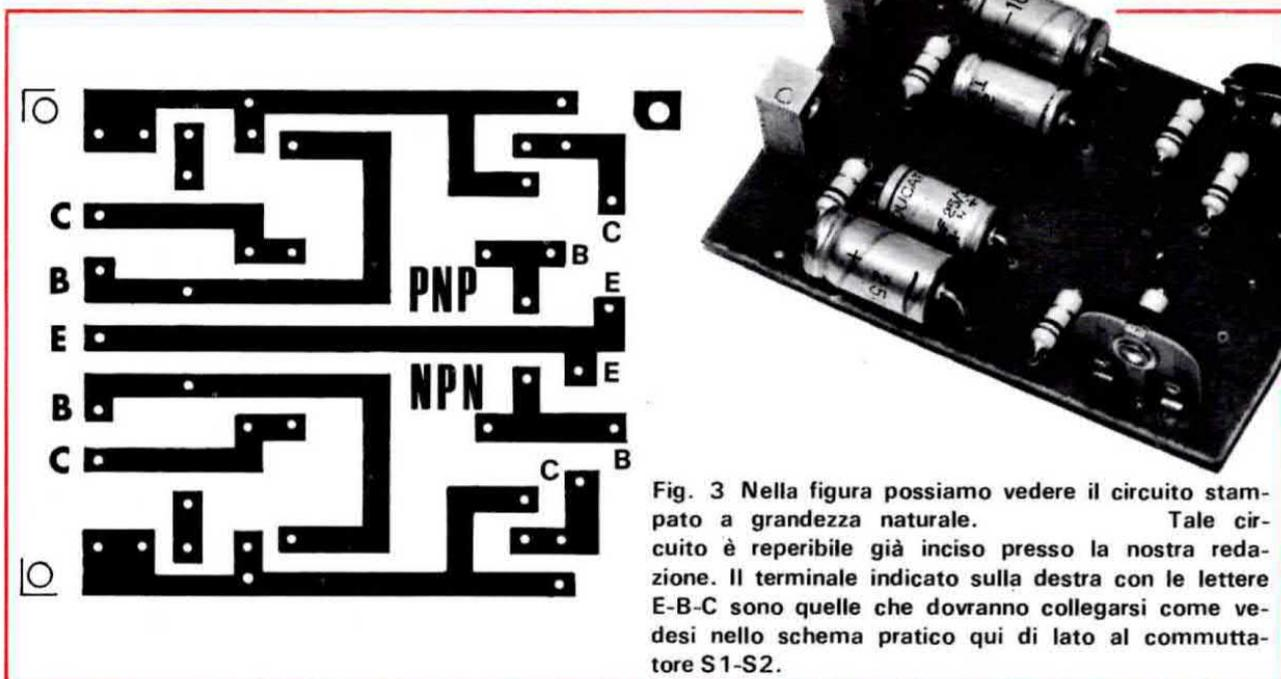
Fig. 3 Nella figura possiamo vedere il circuito stampato a grandezza naturale. Tale circuito è reperibile già inciso presso la nostra redazione. Il terminale indicato sulla destra con le lettere E-B-C sono quelle che dovranno collegarsi come vedesi nello schema pratico qui di lato al commutatore S1-S2.
