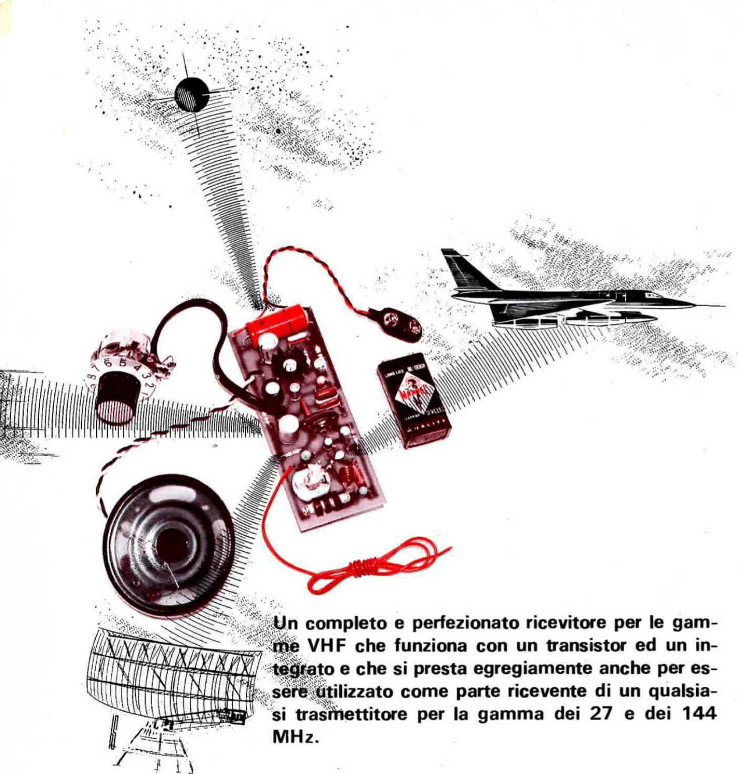
**Un completo e perfezionato ricevitore per le gamme VHF che funziona con un transistor ed un integrato e che si presta egregiamente anche per essere utilizzato come parte ricevente di un qualsiasi trasmettitore per la gamma dei 27 e dei 144 MHz.**
