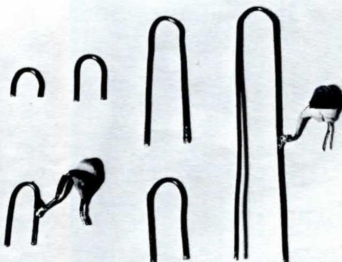
Per le lamelle mobili invece occorrerà saldare un corto spezzone di filo al terminale che fuoriesce di lato per fissarlo dal lato libero alla pista di rame collegata al collettore del transistor ed alle zoccole portabobine.
