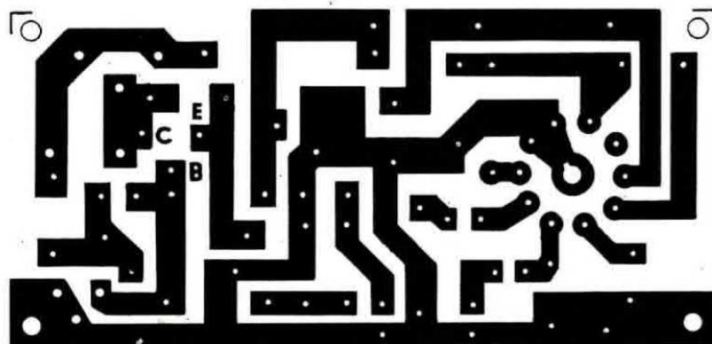
**Fig. 10** Disegno a grandezza naturale del circuito stampato relativo ad un ricevitore monogamma per piccoli ricetrasmittitori per 27 o 144 MHz. Questo circuito realizzato in fibra di vetro è reperibile già inciso presso la nostra redazione.
