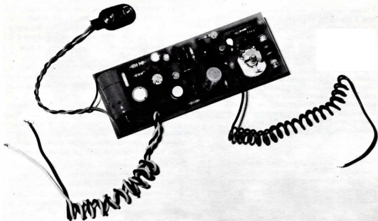
Il segnale di BF viene quindi prelevato direttamente dalla base del transistor tramite una resistenza da 10.000 ohm (R3) ed applicato al condensatore C7 collegato al potenziometro di volume. I due condensatori C6 e C8, che troviamo inseriti tra la massa ed i capi del condensatore C7, servono per attenuare il fruscio della superreazione.
