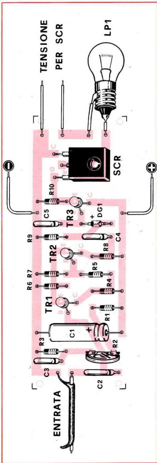
È necessario che l'alimentazione per l'SCR sia effettuata in corrente alternata, affinché la lampadina si accenda in presenza di un segnale, e si spenga quando questo non viene più captato dal ricevitore, pertanto, sui due fili che fuoriescono dal circuito stampato, portanti la dicitura «TENSIONE PER SCR», noi potremo applicare una tensione qualsiasi, come 6-9-12 oppure 220 volt, purché risulti alternata.
