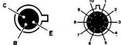
Fig. 2 Nel disegno abbiamo riportato la disposizione dei terminali dei transistor BSX26 e dell'integrato TAA.300 visti dal lato dal quale fuoriescono dal loro corpo. Ovviamente vedendoli dall'alto i piedini verranno a trovarsi invertiti rispetto alla tacca di riferimento, quindi sulla sinistra (per l'integrato TAA.300 avremo il piedino 1 (anziché il 10) quindi il 2 (anziché il 9).
