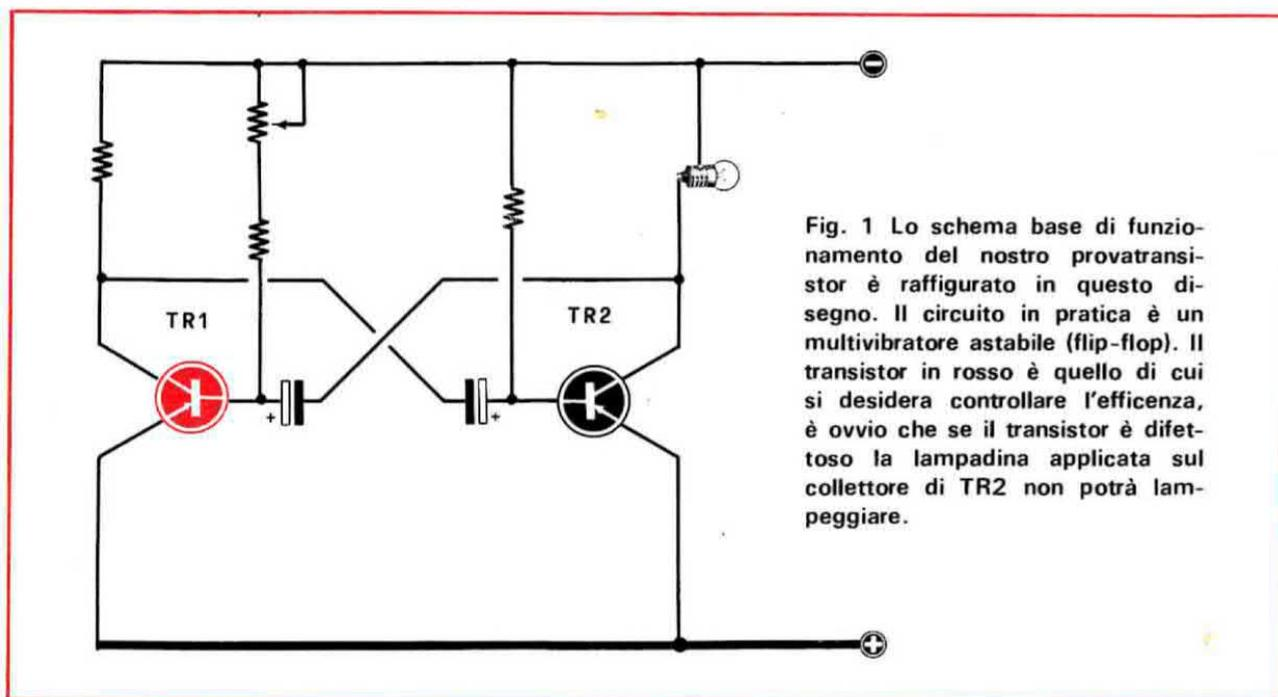
Fig. 1 Lo schema base di funzionamento del nostro provatransistor è raffigurato in questo disegno. Il circuito in pratica è un multivibratore astabile (flip-flop). Il transistor in rosso è quello di cui si desidera controllare l'efficienza, è ovvio che se il transistor è difettoso la lampadina applicata sul collettore di TR2 non potrà lampeggiare.
