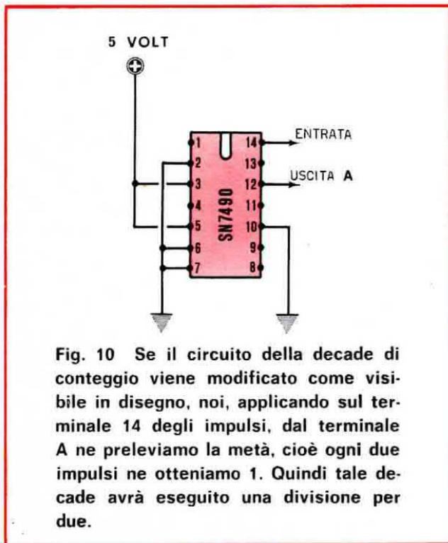
**Fig. 10** Se il circuito della decade di conteggio viene modificato come visibile in disegno, noi, applicando sul terminale 14 degli impulsi, dal terminale A ne preleviamo la metà, cioè ogni due impulsi ne otteniamo 1. Quindi tale decade avrà eseguito una divisione per due.
