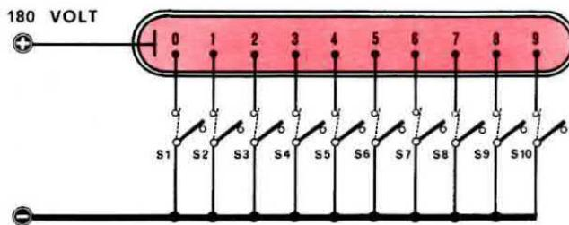
Fig. 1 In una valvola digitale, applicando una tensione positiva di 160-180 volt all'anodo e collegando a massa con interruttori (uno per volta) i dieci catodi a forma di numero, otterremo che questi si illumineranno, diventando così visibili all'esterno.
