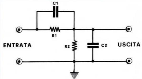
**Fig. 7.** Filtro attenuatore compensatore, da impiegare per pick-up piezoelettrici. Variando i valori di C1 e C2 si possono attenuare o accentuare le note acute o le note gravi (vedi articolo).
