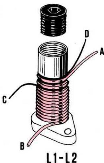
**Fig. 4.** La bobina L2 come vedesi in disegno, andrà avvolta entro la prima spire di L1. Il nucleo ferromagnetico andrà avvitato tanto da poter raggiungere i due avvolgimenti L1-L2 come spiegato in articolo.
