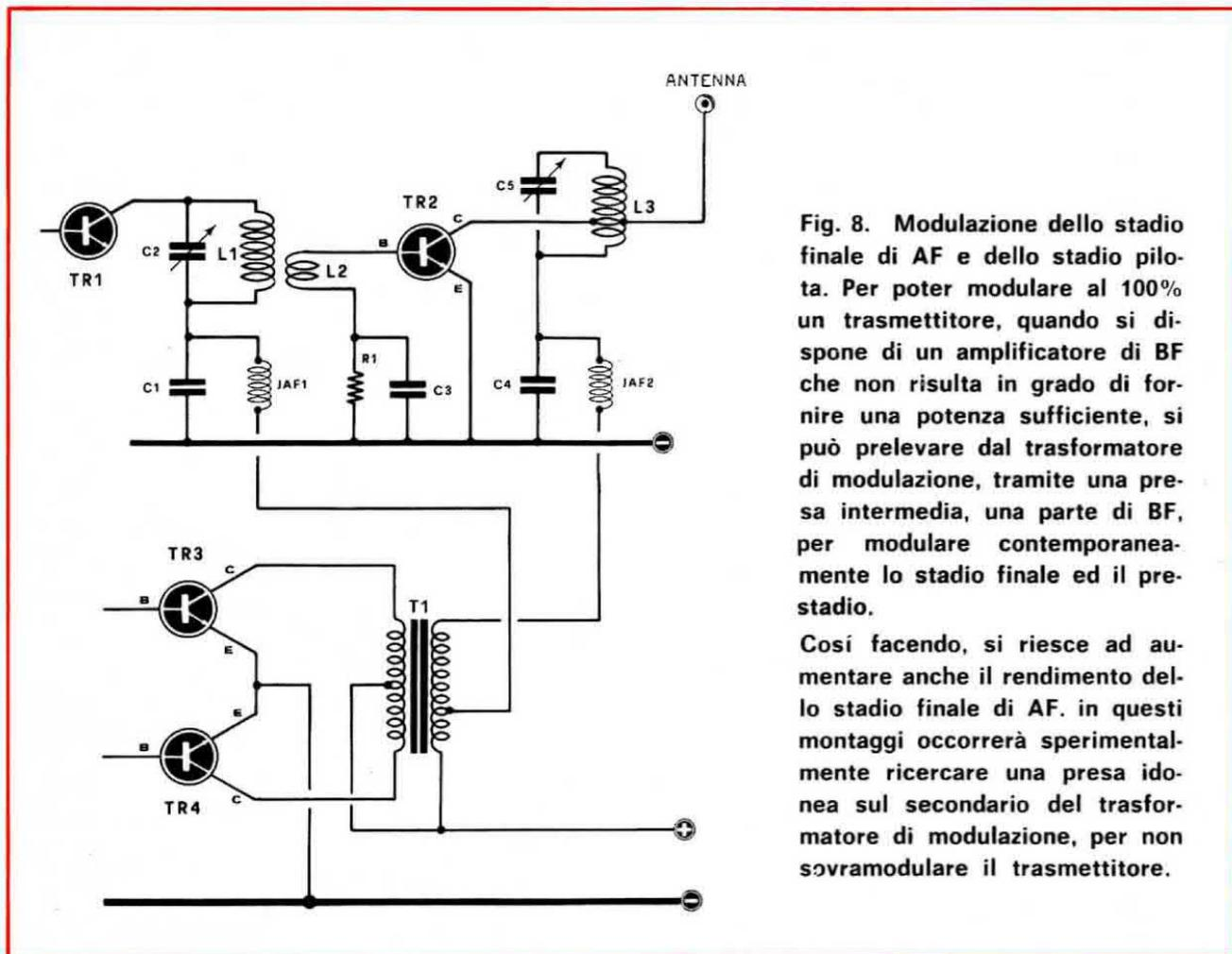
**Fig. 8. Modulazione dello stadio finale di AF e dello stadio pilota.** Per poter modulare al 100% un trasmettitore, quando si dispone di un amplificatore di BF che non risulta in grado di fornire una potenza sufficiente, si può prelevare dal trasformatore di modulazione, tramite una presa intermedia, una parte di BF, per modulare contemporaneamente lo stadio finale ed il pre-stadio.
