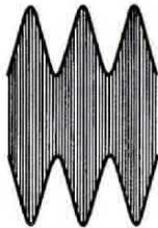
Fig. 14. Se moduliamo il segnale di AF con una frequenza di 1.000 Hz (prelevata da un oscillatore di BF applicato al posto del microfono) al 40-50%, noteremo che il segnale di AF aumenterà di ampiezza, confermandoci che la potenza irradiata subirà anch'essa un aumento. La potenza però si raddoppia soltanto nel caso che la modulazione riesca a raggiungere una percentuale del 100%.
