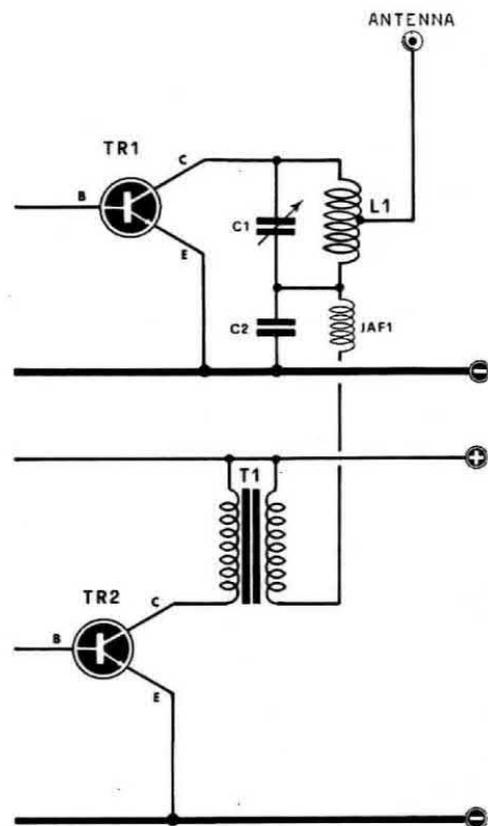
**Fig. 5. Modulazione di collettore tramite un trasformatore di accoppiamento. Questo sistema di modulazione è preferito per le sue qualità. Con esso è possibile adattare le due impedenze di carico (quella dello stadio finale di BF con l'avvolgimento primario e quella dello stadio finale di AF con l'avvolgimento secondario), permettendo così di ottenere un maggior rendimento dei due stadi.**
