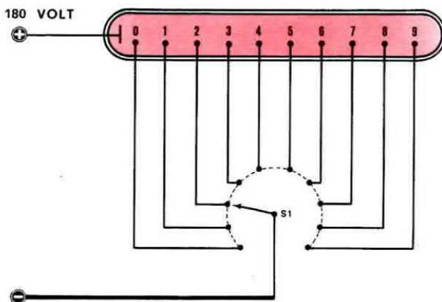
Fig. 2 Quindi, per poter avere una sequenza da 0 a 9 si può utilizzare un commutatore o un relè meccanico che ad ogni impulso possa avanzare di una posizione. Un controllo meccanico presenta però non pochi inconvenienti, primo tra i quali la velocità di commutazione; quindi, per realizzare dei contatori digitali, occorre assolutamente impiegare dei commutatori elettronici transistorizzati.
