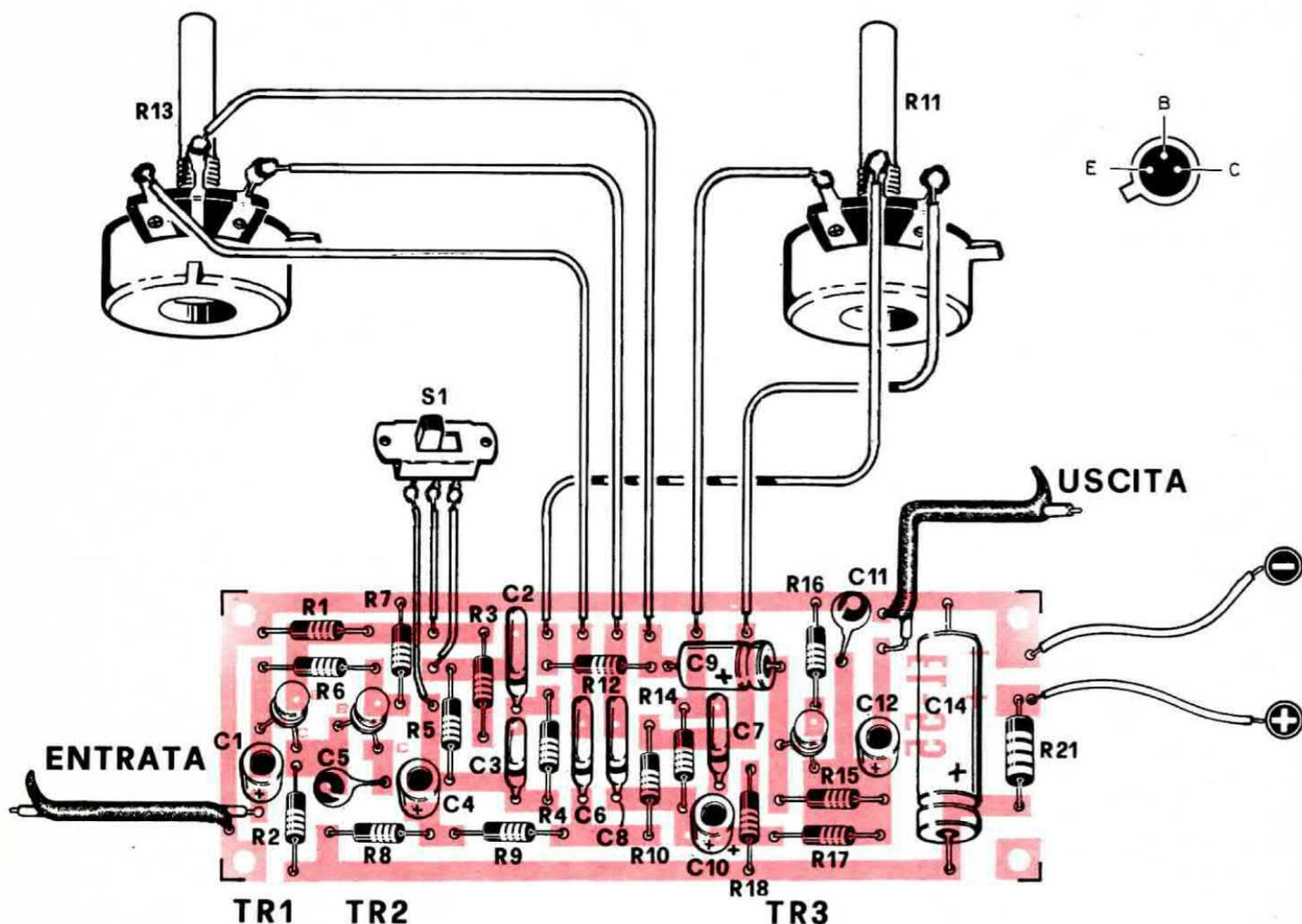
**Fig. 3. Disposizione dei vari componenti sul circuito stampato. Il lettore dovrà fare attenzione a non confondere la polarità dei condensatori elettrolitici, né quella dei terminali dei transistor (vedi disegno in alto). Facciamo presente che i fili che si collegano ai potenziometri e al deviatore S1 dovranno risultare schermati. La calza metallica andrà collegata alla massa.**
