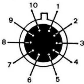
**Fig. 7. Disposizione dei terminali dell'integrato TAA.300 vista dal lato in cui essi fuoriescono dallo zoccolo. Come vedesi dallo schema elettrico, o, ancor meglio, dallo schema pratico, i terminali 1 e 10 dovranno essere collegati a massa.**
