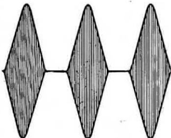
Fig. 16. Se la percentuale di modulazione supera il 100%, si ottiene la cosiddetta « sovr modulazione ». Un segnale sovr modulato si presenta sullo schermo dell'oscilloscopio come quello visibile in disegno, cioè al centro le varie semionde risultano spezzate. In ricezione un segnale sovr modulato risulta notevolmente distorto, tanto da rendere incomprensibili le parole.
