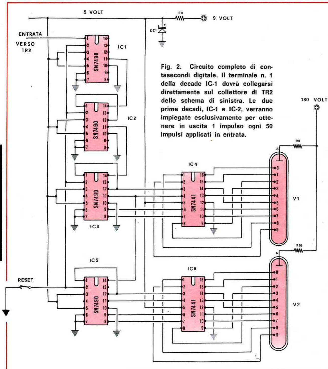
Fig. 2. Circuito completo di contasecondi digitale. Il terminale n. 1 della decade IC-1 dovrà collegarsi direttamente sul collettore di TR2 dello schema di sinistra. Le due prime decadi, IC-1 e IC-2, verranno impiegate esclusivamente per ottenere in uscita 1 impulso ogni 50 impulsi applicati in entrata.
