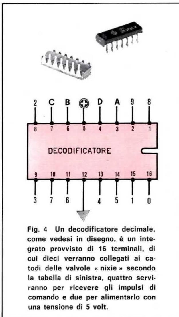
Fig. 4 Un decodificatore decimale, come vedesi in disegno, è un integrato provvisto di 16 terminali, di cui dieci verranno collegati ai catodi delle valvole « nixie » secondo la tabella di sinistra, quattro serviranno per ricevere gli impulsi di comando e due per alimentarlo con una tensione di 5 volt.
