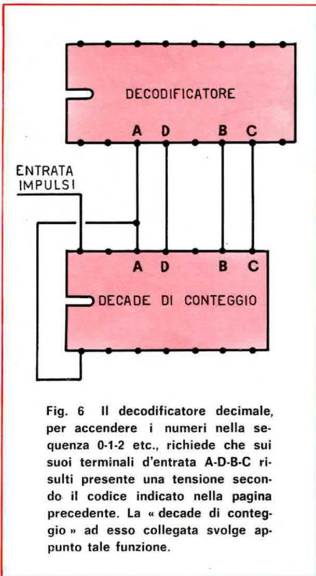
**Fig. 6** Il decodificatore decimale, per accendere i numeri nella sequenza 0-1-2 etc., richiede che sui suoi terminali d'entrata A-D-B-C risulti presente una tensione secondo il codice indicato nella pagina precedente. La « decade di conteggio » ad esso collegata svolge appunto tale funzione.
