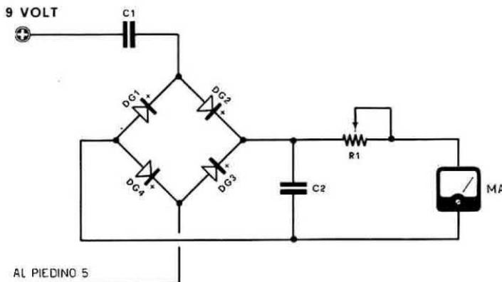
**Fig. 6.** Applicando in parallelo all'altoparlante il circuito qui rappresentato, noi potremo completare il nostro signal-tracer con un indicatore di segnale, utilissimo per la taratura dei nuclei delle Medie Frequenze e per i compensatori dei gruppi AF.
