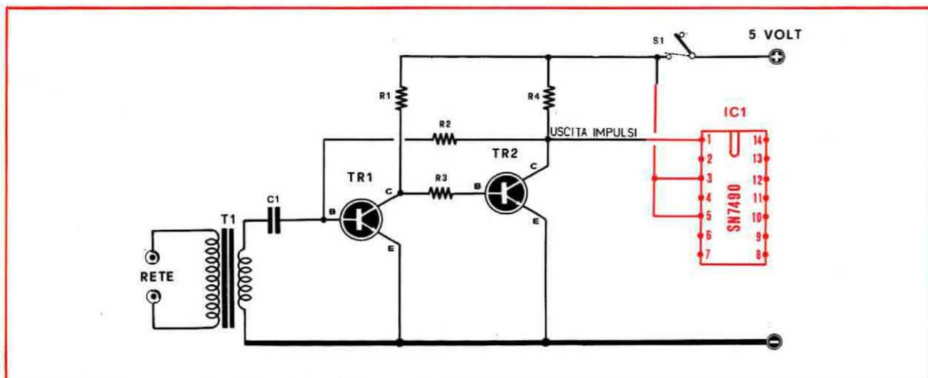
Fig. 1. Utilizzando il circuito qui sopra indicato, noi possiamo ottenere da una tensione alternata di 10-12 volt 50 impulsi al secondo, che verranno utilizzati per pilotare una decade di conteggio (IC-1 del disegno di destra) che divida per 5. A sua volta tale decade ne piloterà una seconda (IC-2) che divida per 10, in modo da ottenere in uscita 1 impulso ogni secondo.
