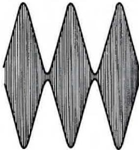
Fig. 15. Quando la potenza di BF è tale da riuscire a modulare al 100% il segnale di AF, potremo notare sull'oscilloscopio che l'ampiezza del segnale ricevuto aumenta quasi del doppio rispetto a quella del segnale di AF privo di modulazione (vedi fig. 13). In un trasmettitore occorre sempre cercare di ottenere tale limite consentito, poiché è solo in queste condizioni che si ottiene il massimo rendimento del trasmettitore.
