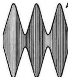
**Fig. 1.** Un segnale di AF sprovvisto di modulazione si presenta come visibile nel disegno di sinistra, cioè perfettamente lineare. Se aggiungiamo a tale segnale uno di BF (vedi disegno al centro), l'ampiezza del segnale di AF risulterà modificata come vedesi nel disegno di destra, cioè sulle due estremità inferiori risulterà presente la sinusoide del segnale di BF. Il segnale di destra, in definitiva, è un segnale di AF modulato.
