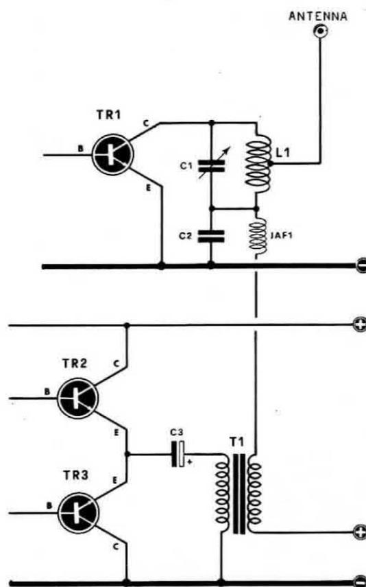
**Fig. 6. Modulazione di collettore con stadio finale di BF in single-ended.** Questo sistema di modulazione consente di impiegare dei trasformatori di modulazione di basso costo, richiedendo un avvolgimento primario a poche spire (impedenza 4-8 ohm). In trasmettitori di potenza, presenta lo svantaggio di richiedere per l'alimentazione dello stadio di BF una tensione doppia rispetto ad uno stadio finale di push-pull, per poter erogare una identica potenza di BF.
