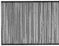
Fig. 13. Se avete un oscilloscopio, prelevando dalla MF di un ricevitore un segnale di AF privo di modulazione apparirà sullo schermo dell'oscilloscopio un segnale rettangolare come quello indicato in figura. L'ampiezza verticale aumenterà all'aumentare della potenza, quindi tale controllo potrebbe risultare utile anche per la taratura del trasmettitore.
