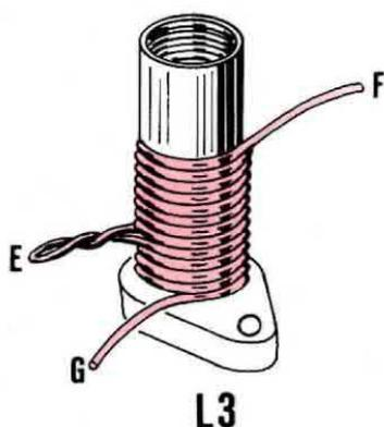
**Fig. 5.** La bobina L3 deve risultare provvista di una presa « E » alla 2,5° spira dal lato « G ». Tale presa servirà per l'emettitore di TR2. Questa bobina non richiede l'impiego di un nucleo ferromagnetico.
