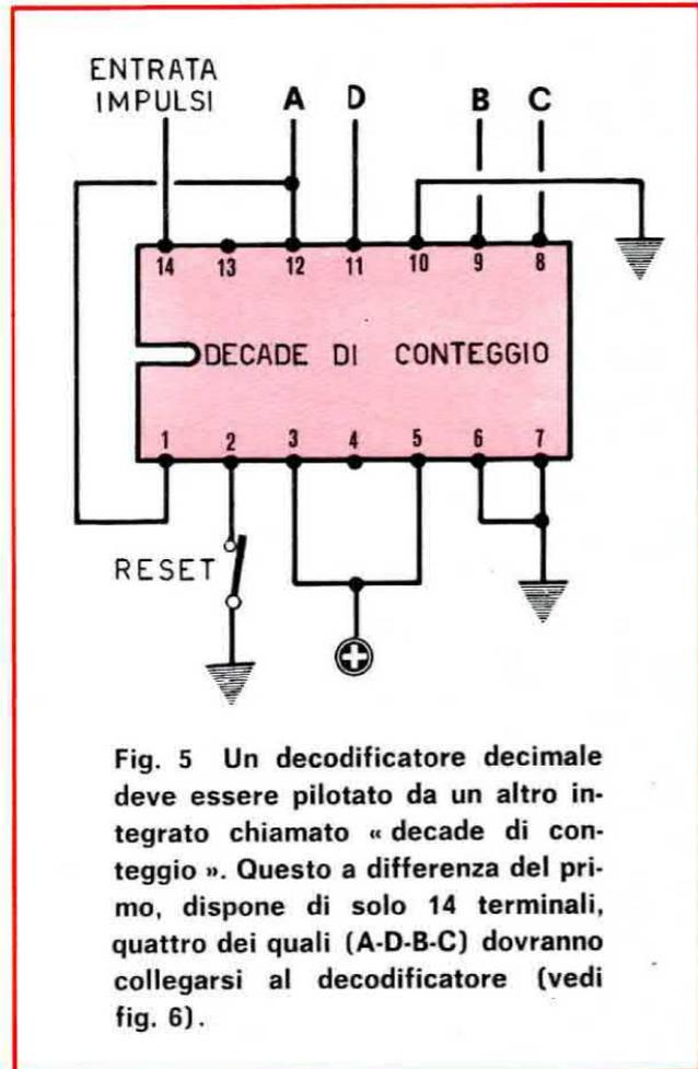
Fig. 5 Un decodificatore decimale deve essere pilotato da un altro integrato chiamato « decade di conteggio ». Questo a differenza del primo, dispone di solo 14 terminali, quattro dei quali (A-D-B-C) dovranno collegarsi al decodificatore (vedi fig. 6).
