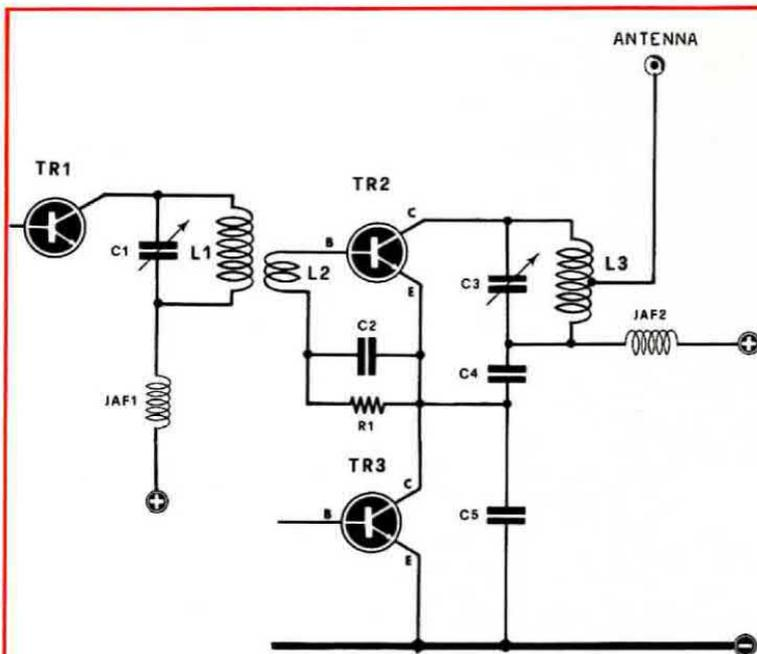
**Fig. 4.** Modulazione in serie. Si noti come l'emettitore dello stadio finale di AF, anziché essere collegato a massa, risulti collegato sul collettore dello stadio finale di BF. Questo sistema è raramente impiegato per la realizzazione di trasmettitori di potenza, per cui riteniamo non valga la pena di prenderlo in considerazione.
