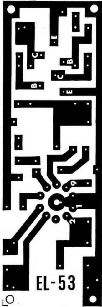
Fig. 4. A destra il disegno a grandezza naturale del circuito stampato del signal-tracer da noi denominato EL-53.
