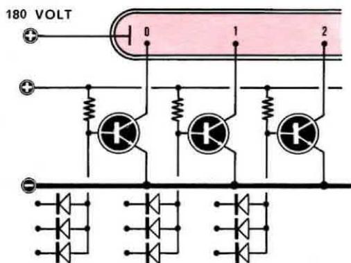
Fig. 3 Un commutatore elettronico può essere realizzato con diodi SCR, oppure con transistor. Il circuito che pilota i vari catodi è progettato in modo che ad un primo impulso un transistor cortocircuiti a massa il primo numero, ad un secondo impulso si sblocchi il primo transistor ed entri in conduzione un altro transistor che cortocircuiti a massa il secondo numero e così via fino al numero 9.
