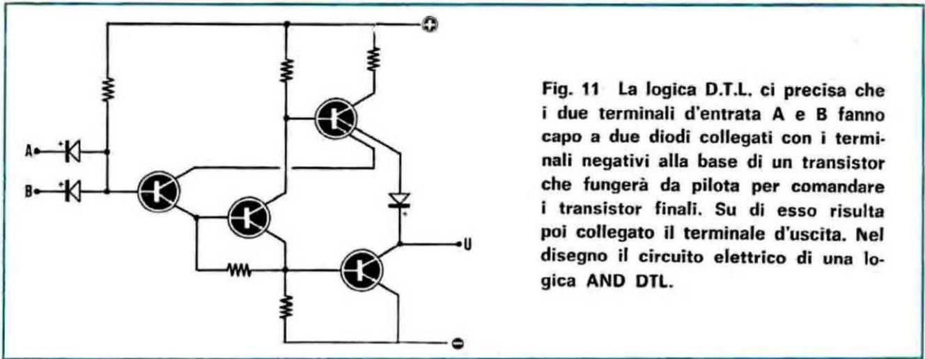
Fig. 11 La logica D.T.L. ci precisa che i due terminali d'entrata A e B fanno capo a due diodi collegati con i terminali negativi alla base di un transistor che fungerà da pilota per comandare i transistor finali. Su di esso risulta poi collegato il terminale d'uscita. Nel disegno il circuito elettrico di una logica AND DTL.
