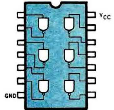
Fig. 20/A Integrato digitale composto da 6 INVERTER. Si noti come in questo disegno l'inverter venga rappresentato come un NAND a entrata singola.
