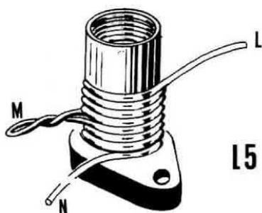
**Fig. 4/C** La bobina dello stadio finale risulterà sprovvista di nucleo. Ricordatevi che il terminale N è quello che dovrà collegarsi alla massa mentre il terminale L al compensatore C20. La presa M risulterà effettuata alla 2,5° spira dal lato del terminale N.
