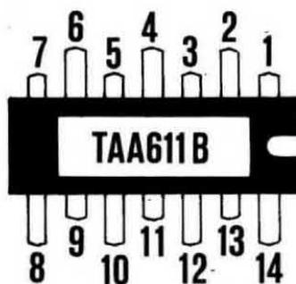
**Fig. 3** Il circuito integrato TAA611, che qui rappresentiamo ingrandito 3 volte, presenta in realtà dimensioni veramente ridotte (12 x 4 mm.). I terminali di questo integrato, come vedesi in disegno, risultano disposti in modo che, se non lo inseriremo sul circuito stampato nel suo giusto verso, non potremo farlo entrare.
