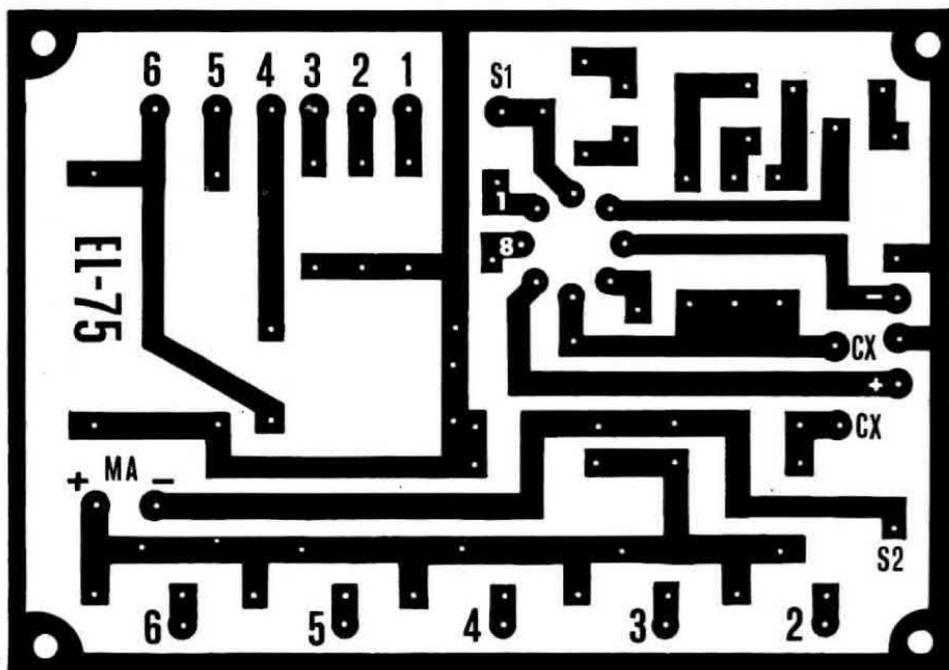
Fig. 5 Circuito stampato a grandezza naturale del capacimetro. I numeri dall'1 ai 6 visibili in alto andranno a collegarsi a S1, quelli in basso, dal 2 al 6, a S2. I due terminali contrassegnati con CX si collegheranno ai due terminali esterni, indispensabili per applicare il condensatore da misurare.
