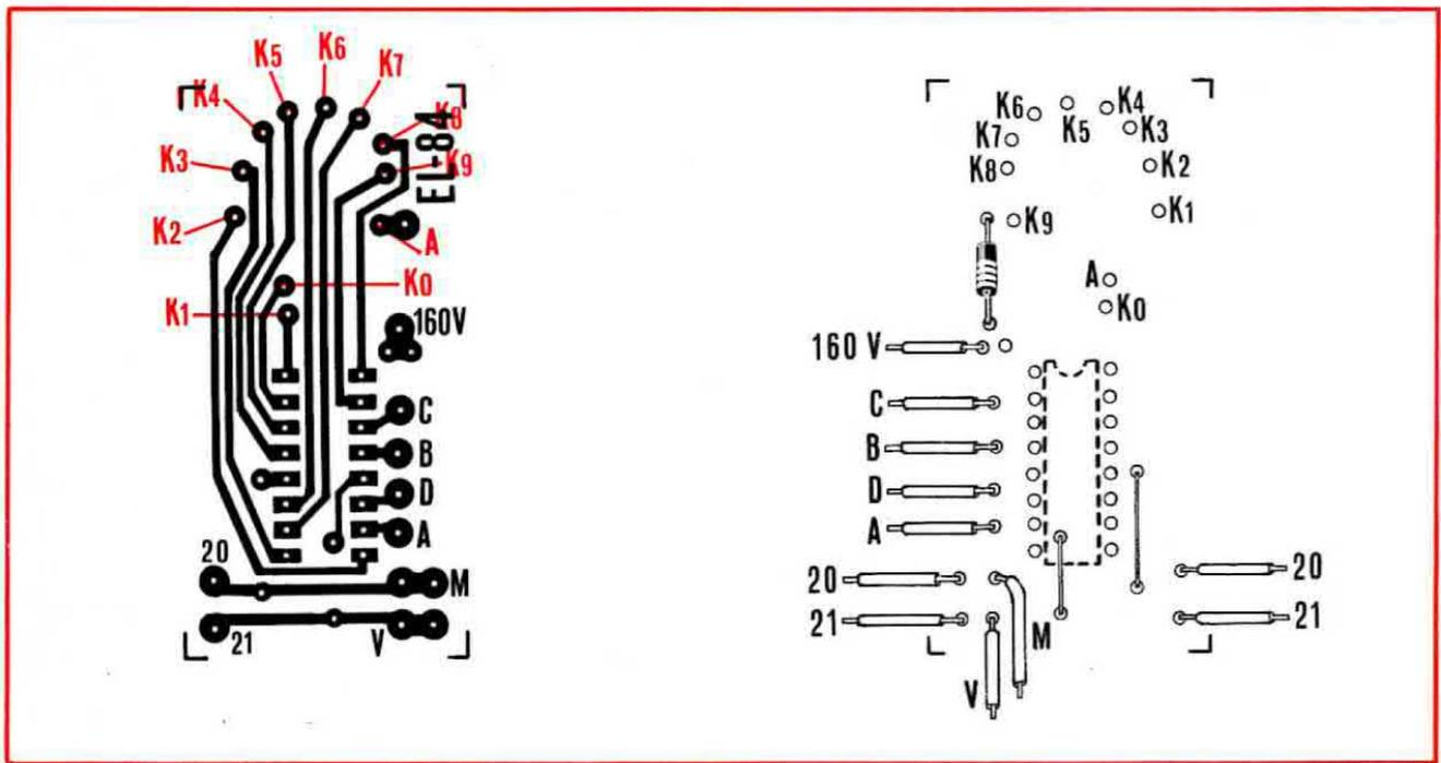
Fig. 18 Circuito stampato a grandezza naturale del telaio EL84. Su questa basetta oltre all'integrato IC9 o IC11 andrà inserito anche la valvola digitale nixie modello GN6. Di questi telai come vedesi in fig. 7 ne occorrono due.
