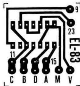
Fig. 15 Circuito stampato a grandezza naturale del telaio EL83. Di questi telai ne occorrono due, uno per i secondi ed uno per le decine, come vedesi in Fig. 7.
