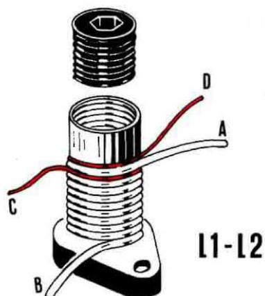
**Fig. 4/A** La bobina oscillatrice L1 andrà avvolta come vedesi in disegno. In alto dove abbiamo il terminale A inseriremo tra la prima spira la bobina link L2. Il nucleo ferromagnetico andrà avvitato tanto da poter raggiungere le prime spire di L1-L2.
