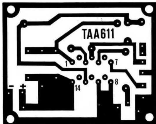
**Fig. 2** Circuito stampato a grandezza naturale dell'amplificatore di BF adatto per altoparlante da 8 ohm 3 watt, oppure per cuffie stereofoniche. I lettori che volessero realizzare un amplificatore stereofonico dovranno logicamente utilizzare due circuiti stampati. Consigliamo di eseguire i fori per i terminali dell'integrato con una punta da 1 mm. e di non saldare i piedini non utilizzati, cioè il n. 2-6-9-11-13, al circoletto in rame presente sul circuito stampato.
