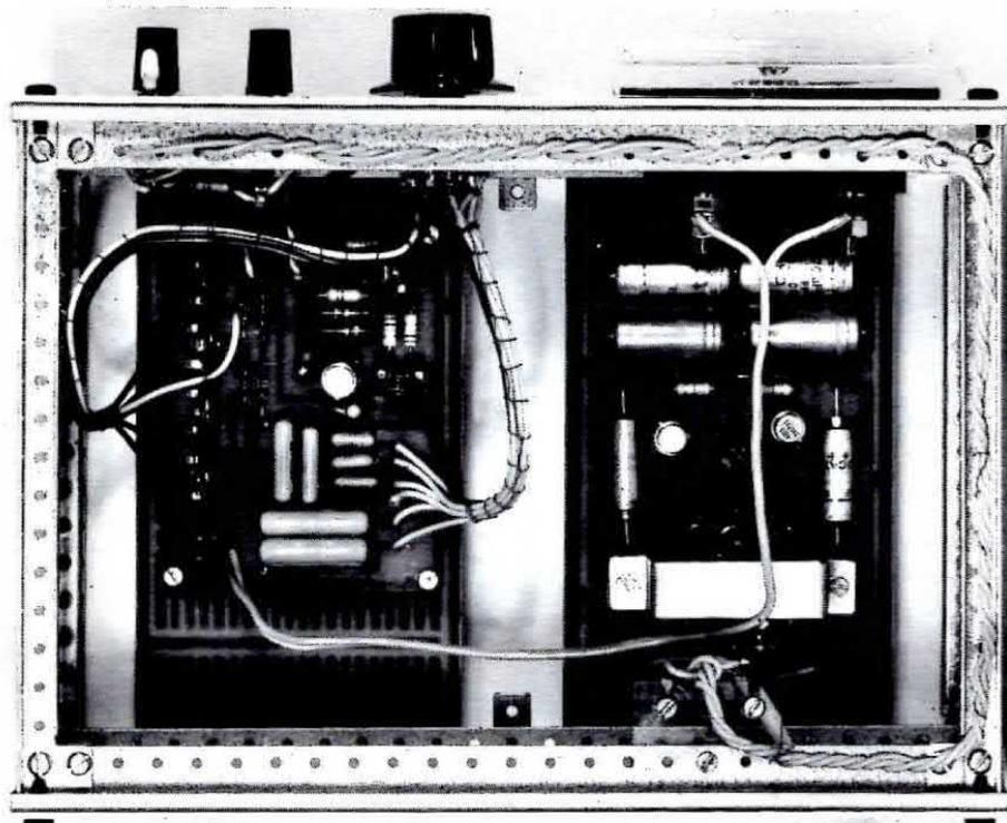
**Nella scatola metallica da noi acquistata per racchiudere il nostro capacimetro, i due circuiti stampati relativi all'alimentatore e all'oscillatore ad onde quadre con l'uA. 709 sono stati disposti come vedesi in questa foto.**
