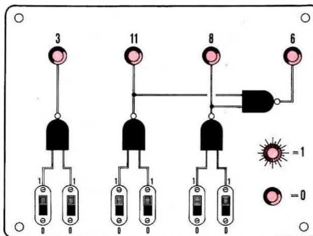
**Fig. 5** Per dimostrazioni didattiche, i Professori potranno far realizzare ai loro allievi un pannello sul quale risulteranno raffigurati graficamente i simboli dei NAND e le relative connessioni elettriche. Sulle diverse entrate saranno presenti i deviatori per le condizioni 0 e 1 e sulle uscite, le lampadine spia. Logicamente sotto al pannello verrà effettuato il circuito elettrico di fig. 3 e di fig. 4.
