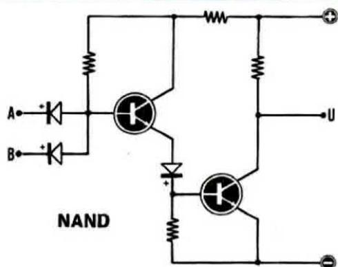
Fig. 14 Il circuito elettrico di una logica può variare considerevolmente da una Casa Costruttrice all'altra. Esistono logiche con identica funzione provviste di due soli transistor, altre invece ne possiedono quattro o cinque per ottenere caratteristiche migliorate. Ad esempio, in questo disegno, si può notare come una semplice logica NAND non differisca notevolmente dall'inverter di fig. 13.
