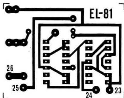
Fig. 9 Disegno a grandezza naturale del circuito stampato tipo EL81. Nel saldare gli integrati IC1-IC2 bisogna fare attenzione alla tacca di riferimento, presente sull'involucro.
