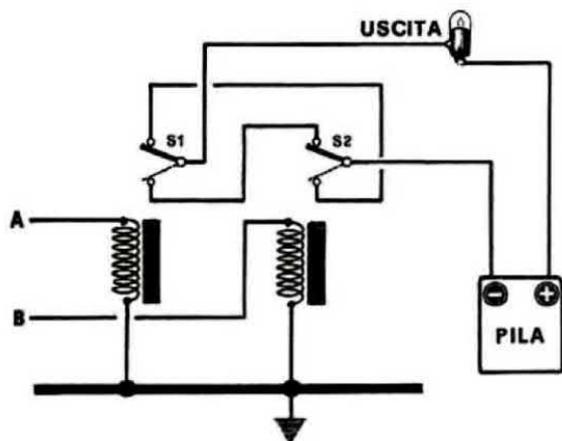
Fig. 8 Se volessimo ottenere con due relé un funzionamento analogo a quello che ci potrebbe fornire una logica OR ESCLUSIVO, dovremmo collegare gli scambi dei relé come indicato in disegno. Applicando tensione sui due terminali A e B alternativamente o contemporaneamente, otterremo una tavola della verità identica a quella di una logica tipo OR ESCLUSIVO (vedi fig. 2).
