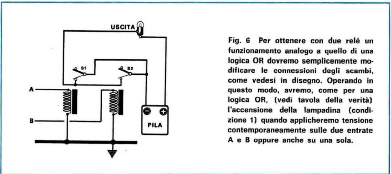
Fig. 6 Per ottenere con due relé un funzionamento analogo a quello di una logica OR dovremo semplicemente modificare le connessioni degli scambi, come vedesi in disegno. Operando in questo modo, avremo, come per una logica OR, (vedi tavola della verità) l'accensione della lampadina (condizione 1) quando applicheremo tensione contemporaneamente sulle due entrate A e B oppure anche su una sola.
