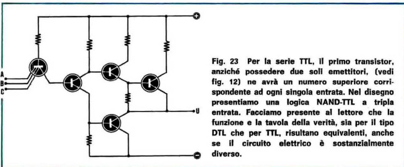
Fig. 23 Per la serie TTL, il primo transistor, anziché possedere due soli emettitori, (vedi fig. 12) ne avrà un numero superiore corrispondente ad ogni singola entrata. Nel disegno presentiamo una logica NAND-TTL a tripla entrata. Facciamo presente al lettore che la funzione e la tavola della verità, sia per il tipo DTL che per TTL, risultano equivalenti, anche se il circuito elettrico è sostanzialmente diverso.
