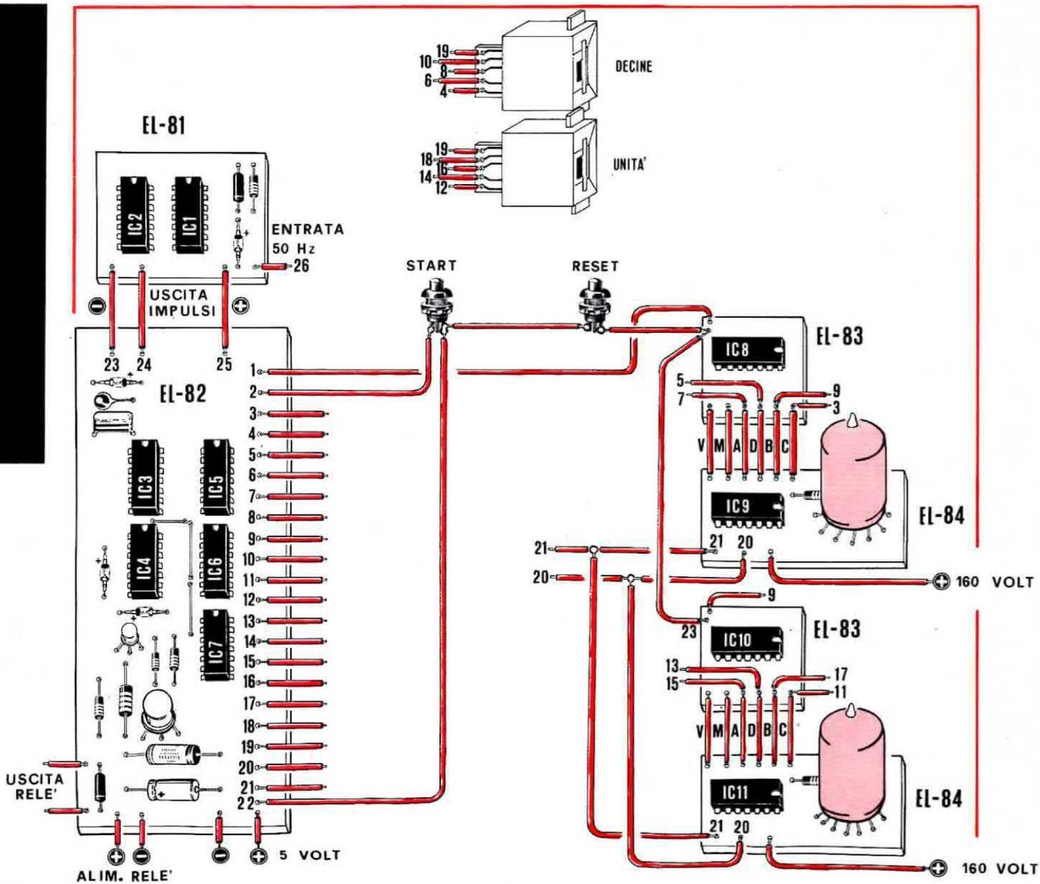
può notare la disposizione dei componenti su tale basetta. Come si può stabilire dal disegno di fig. 7 la basetta EL 81 dovrà essere collegata al telaio premontato EL 82.
