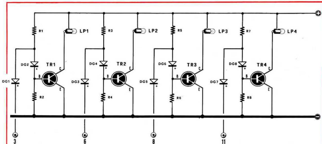
**Fig. 4** Per rendere il progetto ancor più interessante potrete collegare a tutte le uscite 3-6-8-11 dell'integrato questo circuito transistorizzato e ottenere così l'accensione di una lampada spia, quando l'uscita è in « condizione 1 ». Lo spegnimento si ottiene quando si presenta la « condizione 0 ».
