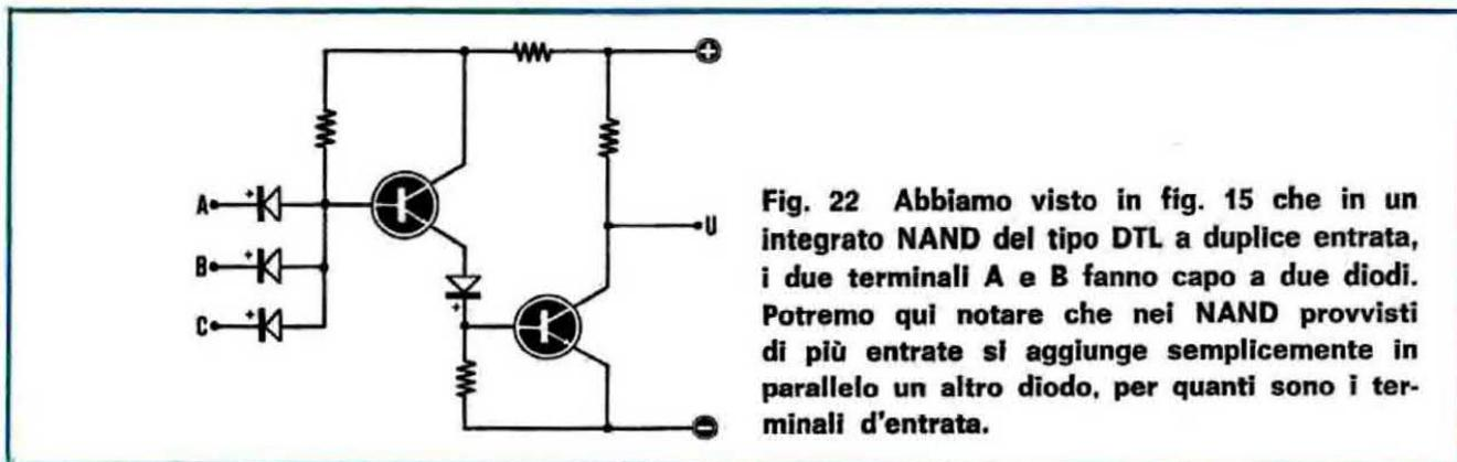
Fig. 22 Abbiamo visto in fig. 15 che in un integrato NAND del tipo DTL a duplice entrata, i due terminali A e B fanno capo a due diodi. Potremo qui notare che nei NAND provvisti di più entrate si aggiunge semplicemente in parallelo un altro diodo, per quanti sono i terminali d'entrata.
