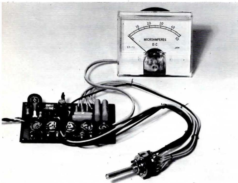
**In questa foto vediamo il capacimetro modello EL.75 come si presenta a montaggio ultimato. Lo strumento da 50 microamper, nel caso si desiderasse una precisione di lettura superiore a quella da noi ottenuta, potrà essere scelto di dimensioni maggiori.**
