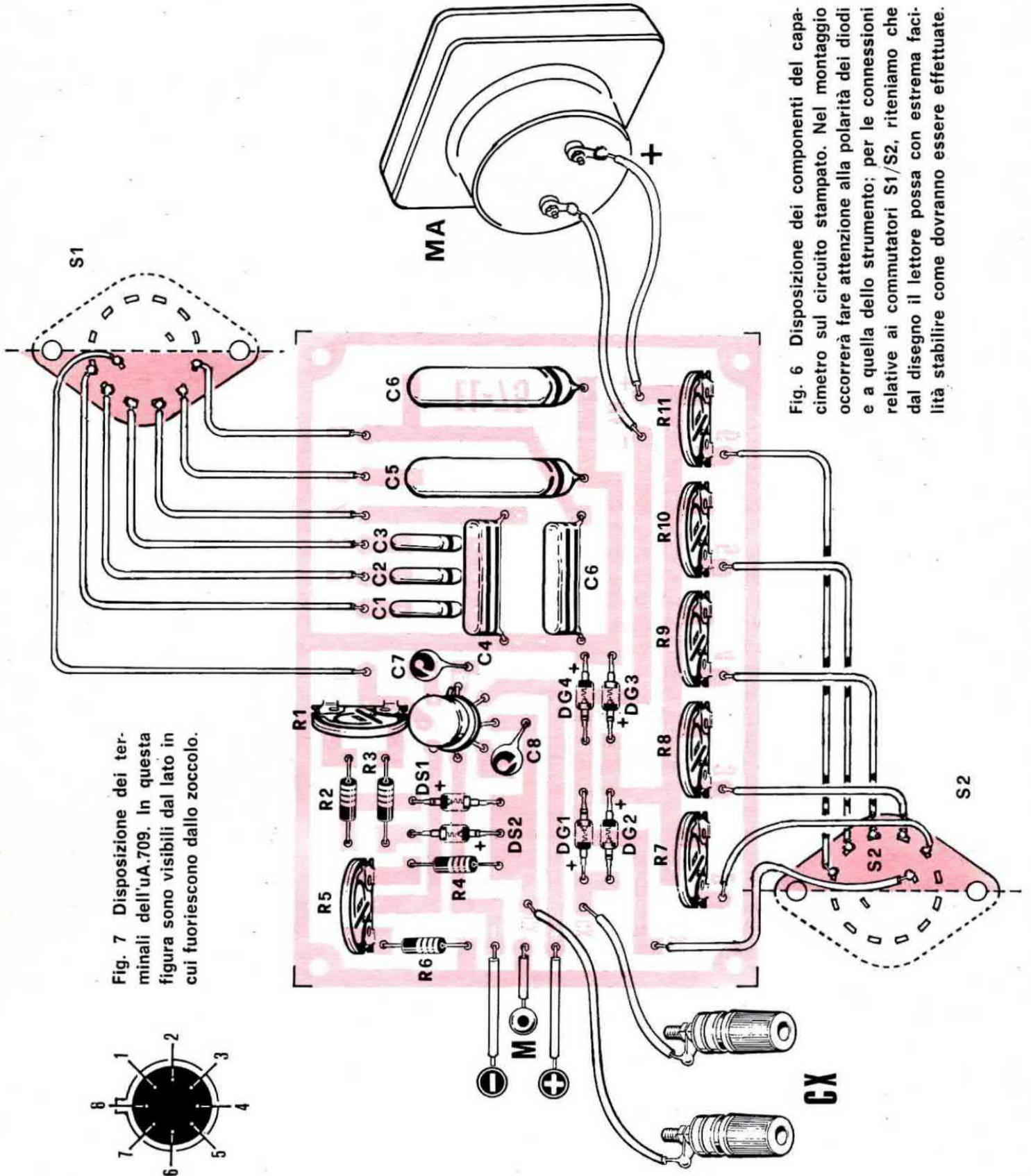
Fig. 6 Disposizione dei componenti del capacitometro sul circuito stampato. Nel montaggio occorrerà fare attenzione alla polarità dei diodi e a quella dello strumento; per le connessioni relative ai commutatori S1/S2, riteniamo che dal disegno il lettore possa con estrema facilità stabilire come dovranno essere effettuate.
