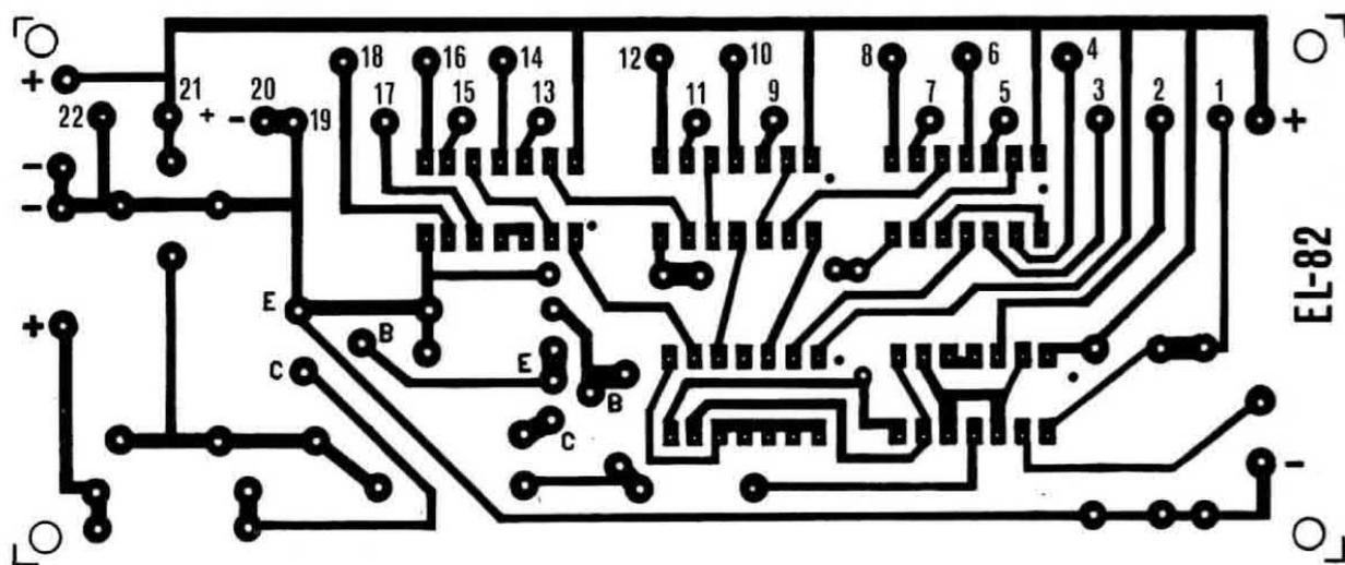
Fig. 12 Circuito stampato a grandezza naturale del telaio della preselezione da noi denominato EL82. Su questo circuito sono presenti anche i due transistor necessari per comandare il relé. Ricordiamo ai lettori che oltre a fornire separatamente i vari circuiti stampati, noi possiamo inviare anche tutti i circuiti necessari, già premontati.
