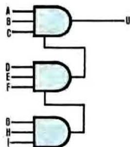
Fig. 25 Possedendo delle logiche provviste di terminale EXPANDER, collegandole in serie (vedi figura) possiamo realizzare un'unica logica con una sola uscita ma con un considerevole numero di entrate. In questo caso è raffigurato un AND a 9 entrate ottenuto con 3 AND a triplice entrata, due delle quali sono provviste di expander.
