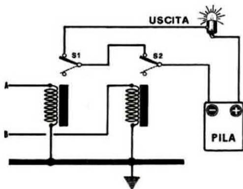
Fig. 9 Questo circuito equivale al funzionamento di una logica tipo NOR. Infatti soltanto quando non viene applicata tensione sui due terminali A e B (condizione 0) vi sarà tensione in uscita (condizione 1 e accensione della lampadina). Ogni altra combinazione ci darà in uscita sempre 0. Il funzionamento di un NOR lo possiamo altresì ottenere, collegando all'uscita di un OR (fig. 6) un INVERTER (vedi fig. 7).
