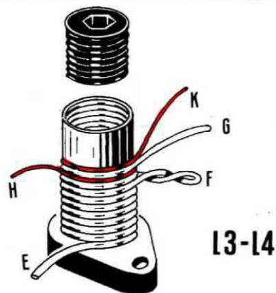
**Fig. 4/B** La bobina dello stadio pilota andrà avvolta in modo che la presa F per l'emettitore di TR2 si trovi posta in alto. Sulle prime spire di L3 avvolgeremo, come vedesi in disegno, il link L4. Anche questa bobina sarà provvista di nucleo
