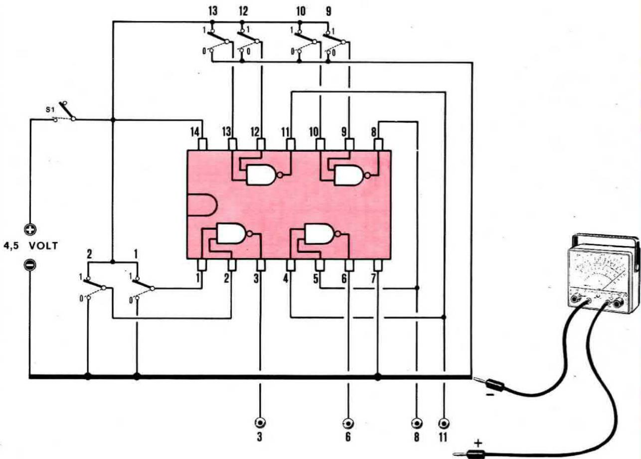
**Fig. 3** Circuito elettrico, in base al quale dovranno risultare collegati i vari terminali dell'integrato, per procedere all'esperienza cui accenniamo in articolo.
