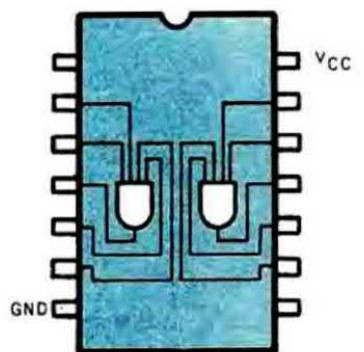
Fig. 21/B Integrato digitale composto da 2 AND a quadrupla entrata. Notare la mancanza del cerchietto, indicante la funzione INVERTER sulle uscite, presente invece nei NAND.
