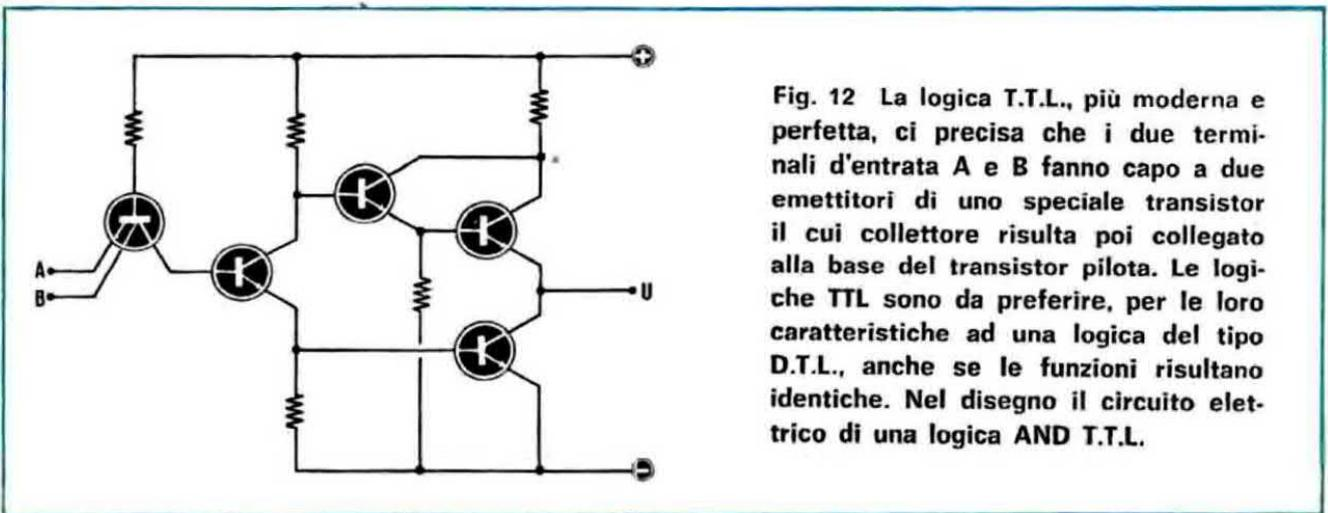
Fig. 12 La logica T.T.L., più moderna e perfetta, ci precisa che i due terminali d'entrata A e B fanno capo a due emettitori di uno speciale transistor il cui collettore risulta poi collegato alla base del transistor pilota. Le logiche TTL sono da preferire, per le loro caratteristiche ad una logica del tipo D.T.L., anche se le funzioni risultano identiche. Nel disegno il circuito elettrico di una logica AND T.T.L.
