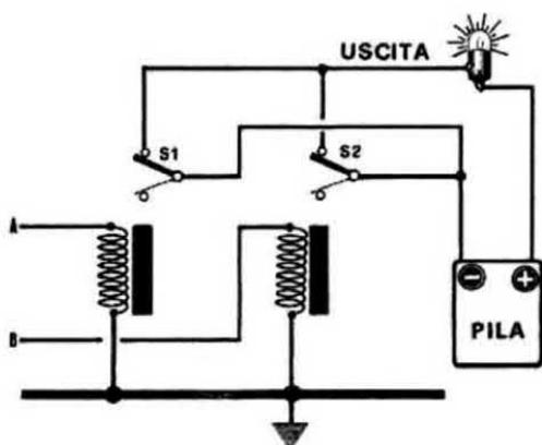
Fig. 10 Se invece desideriamo ottenere con due relé un funzionamento analogo a quello di una logica NAND, dovremo collegare gli scambi del relé, come indicato in disegno. Così facendo, avremo l'accensione della lampadina in uscita, quando sulle entrate non viene applicata nessuna tensione, oppure quando è applicata ad uno solo dei due terminali. Esattamente come ci dimostra la tavola della verità del NAND visibile in fig. 2.
