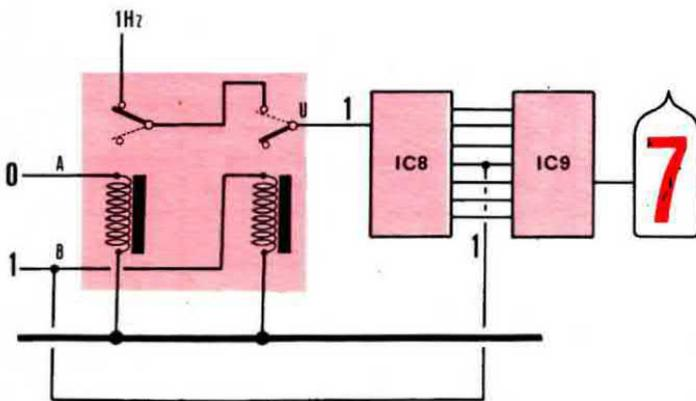
Fig. 3 Infatti, se colleghiamo l'entrata B del NOR al terminale del far accendere il numero 7, quando «decodificatore», che serve per su questo giungerà la tensione, automaticamente giungerà anche sul terminale B e di conseguenza alla decade non giungeranno più gli impulsi di 1 hertz.
