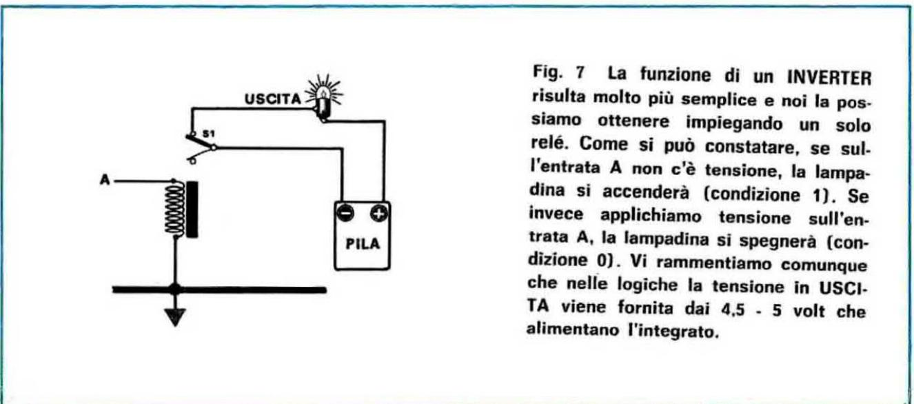
Fig. 7 La funzione di un INVERTER risulta molto più semplice e noi la possiamo ottenere impiegando un solo relé. Come si può constatare, se sull'entrata A non c'è tensione, la lampadina si accenderà (condizione 1). Se invece applichiamo tensione sull'entrata A, la lampadina si spegnerà (condizione 0). Vi rammentiamo comunque che nelle logiche la tensione in USCITA viene fornita dai 4,5 - 5 volt che alimentano l'integrato.
